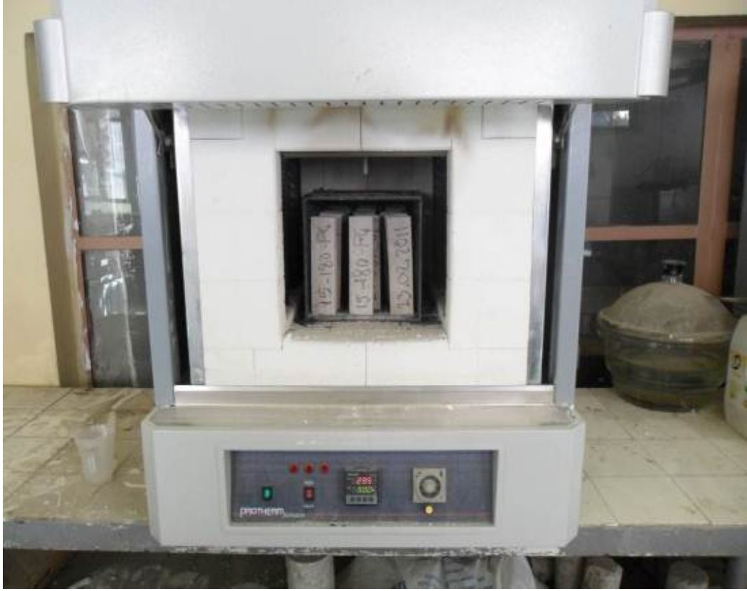
EK-2. Diatomit ikameli numunelerde yüksek sıcaklık uygulanması
