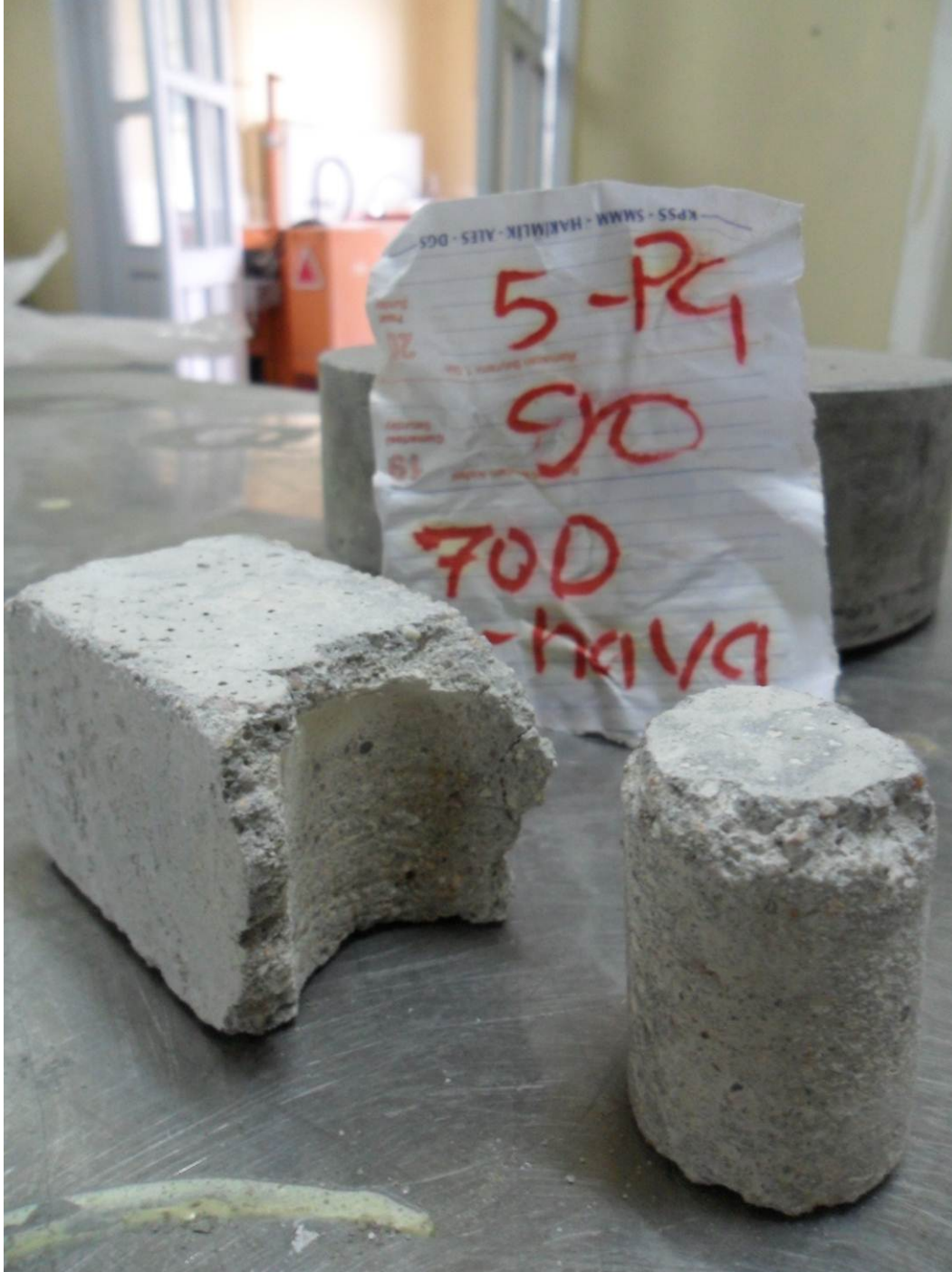
EK-6. 700 °C 'de % 5 diyatomit ikameli havada soğutulan numune karot örneği
