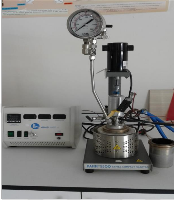
Şekil 3.4. Yüksek sıcaklık-basınç ön arıtma reaktör sistemi
