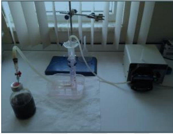
Şekil 3.5. Biyogaz miktarı ölçüm düzeneği
