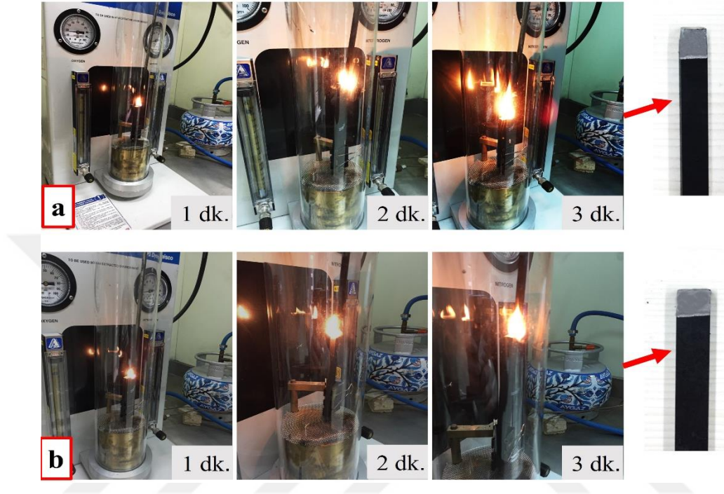
Şekil 48. (a) N3 ve (b) N5 hibrit kompozit numunelerinin yanma davranışı
