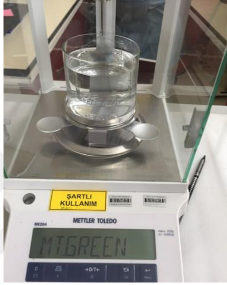
Şekil 24 Arşimet yöntemi deney düzeneği
