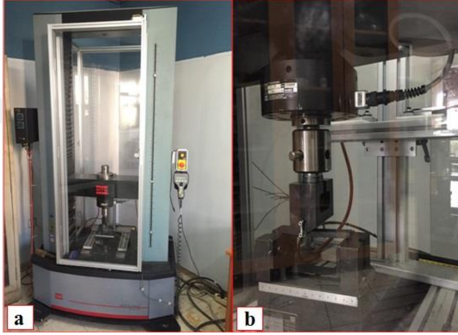
Şekil 29. Eğme testi cihazı görüntüsü ve deney anı
