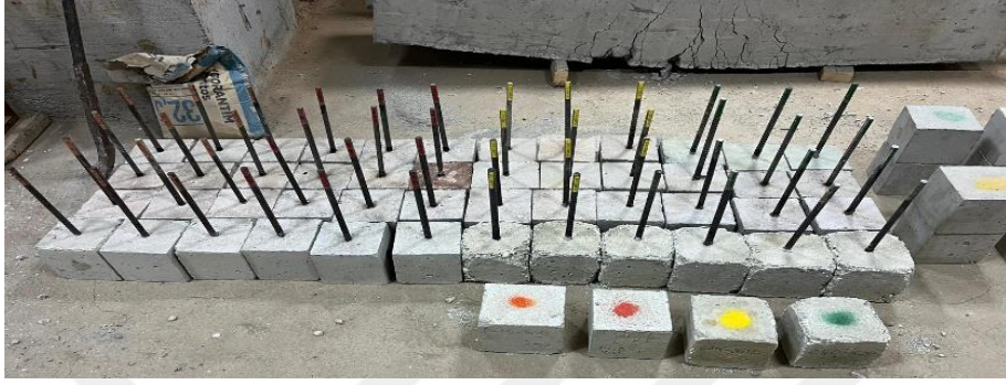
Şekil 3. 7. Numune renklendirme ve etiketleme.
