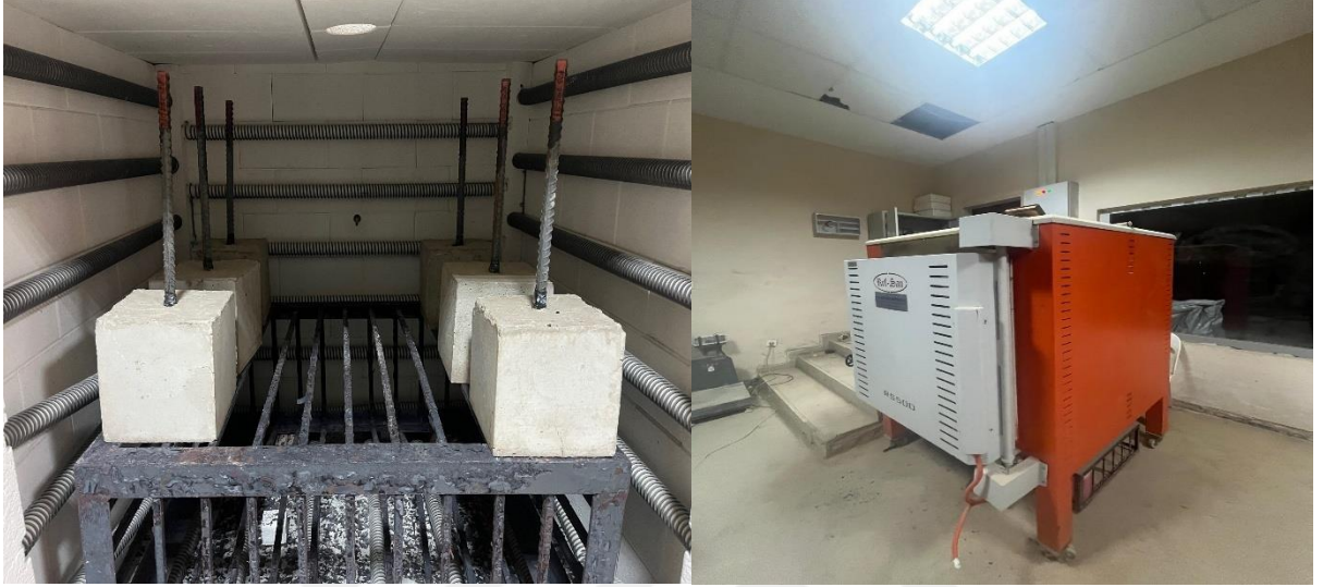
Şekil 3. 9. Yüksek sıcaklık deneyi için kullanılan fırın.
