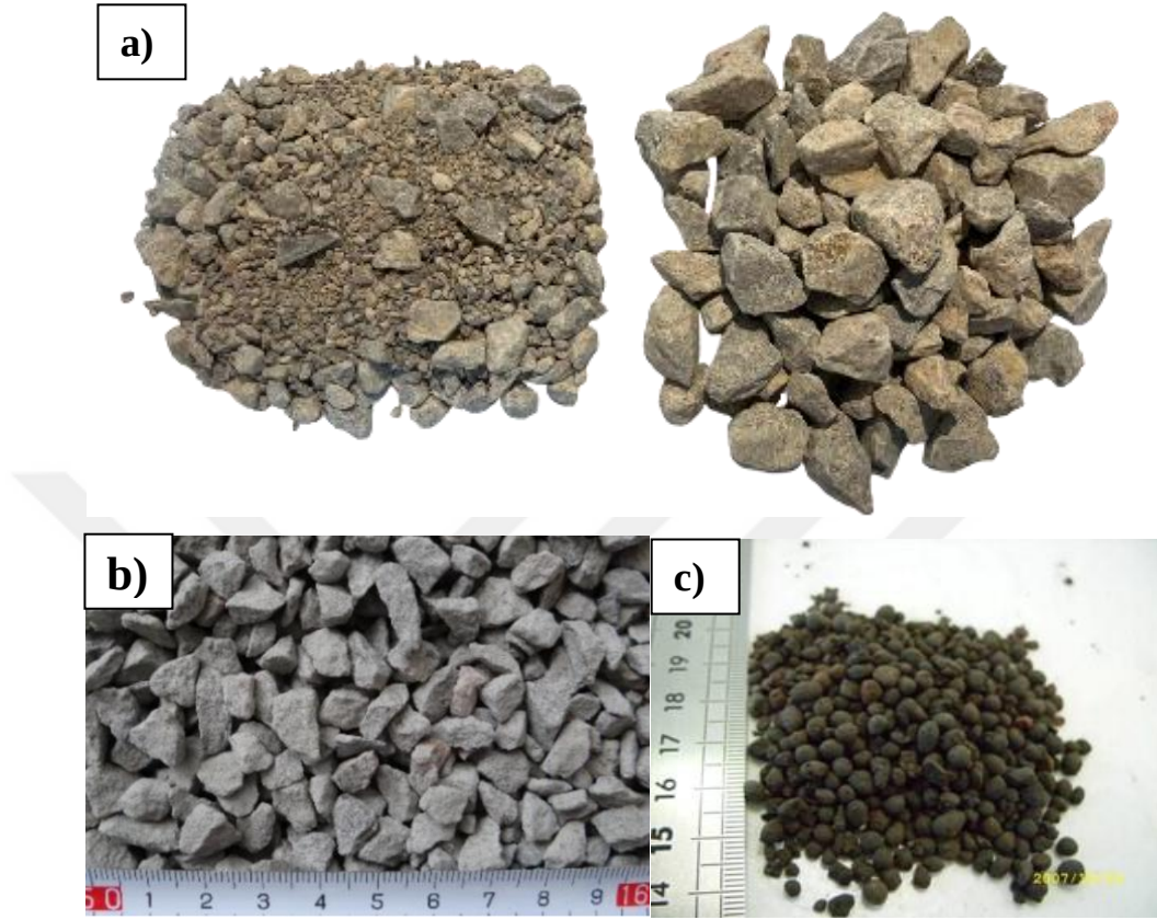
Şekil 1. 2 a) perlit b) dolamit c) Keramzit.
