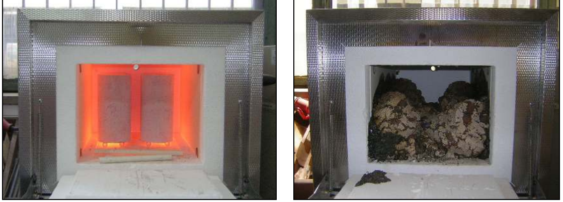
a) Numunelerin yüksek sıcaklık etkisine maruz bırakılması b) 1200°C sıcaklıkta dağılan numuneler
