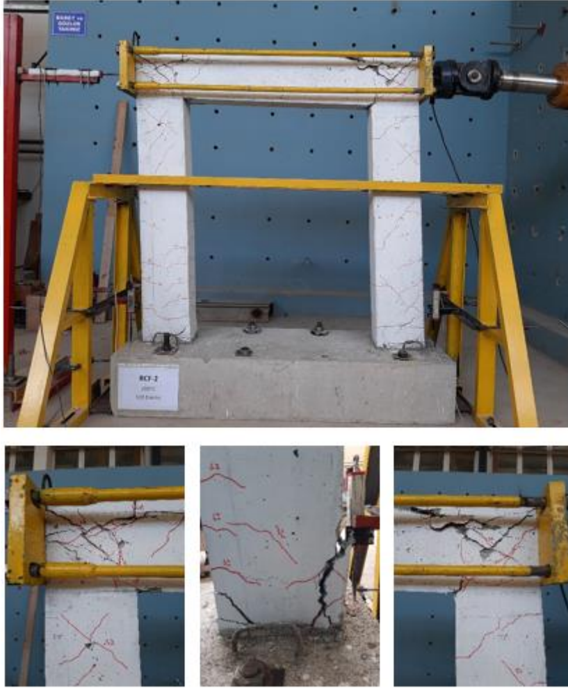
Şekil 62. Deney sonu RCF_2_200_120 deney elemanında oluşan hasar durumları
