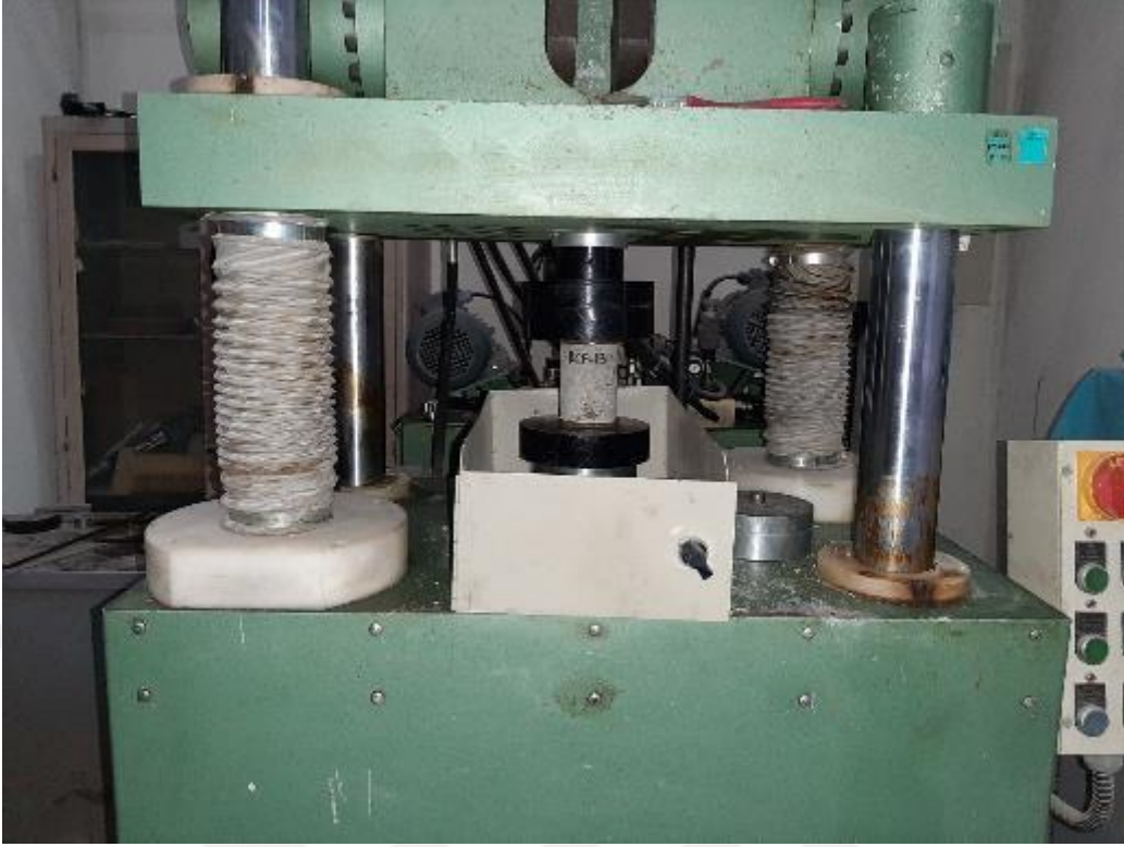
Şekil 86. Beton karot numunelerinin basınç dayanımının belirlenmesi
