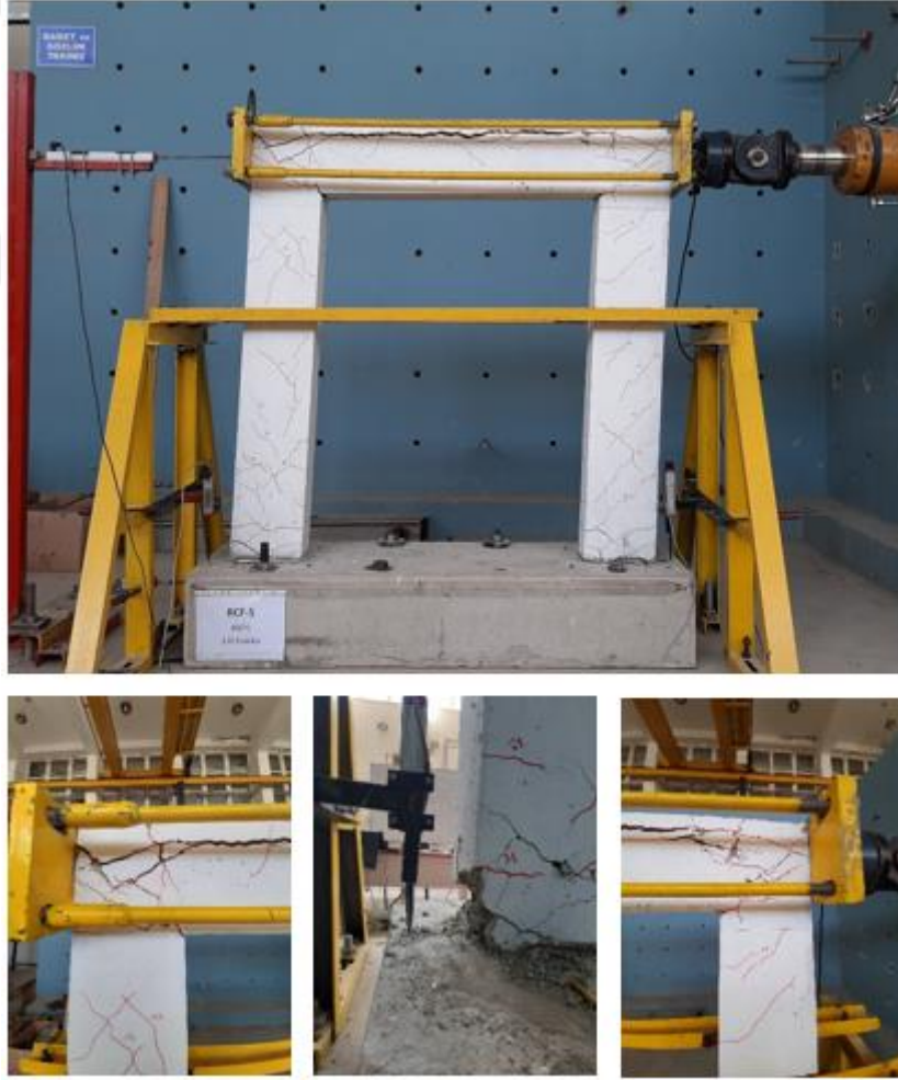
Şekil 65. Deney sonu RCF_5_400_120 deney elemanında oluşan hasar durumları
