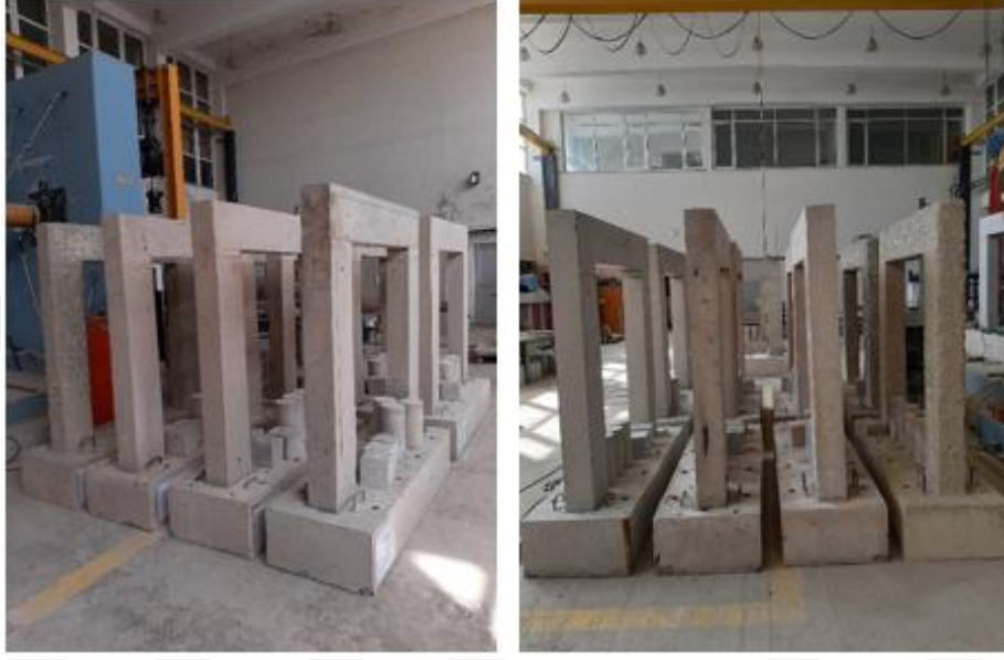
Şekil 17. Yüksek sıcaklık etkisine maruz kalan betonarme çerçeve numuneler
