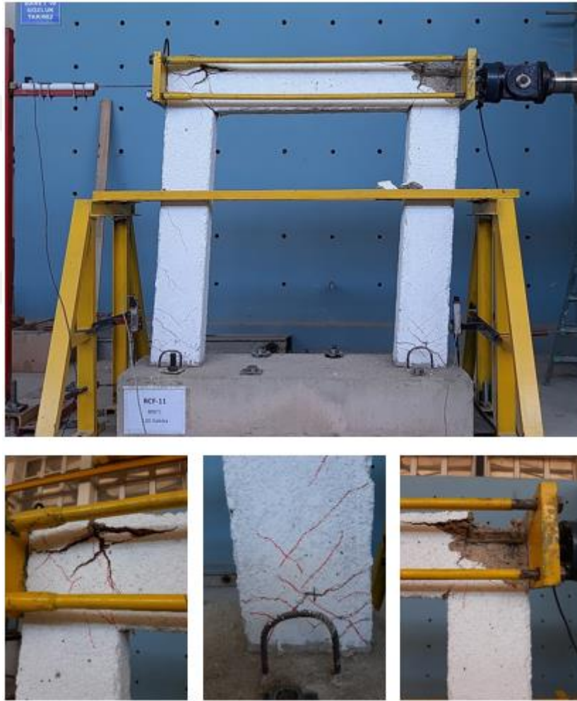
Şekil 71. Deney sonu RCF_11_800_120 deney elemanında oluşan hasar durumları
