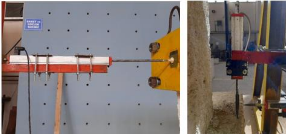
řekil 24. Doğrusal potansiyometrik cetvel (LPDT)
