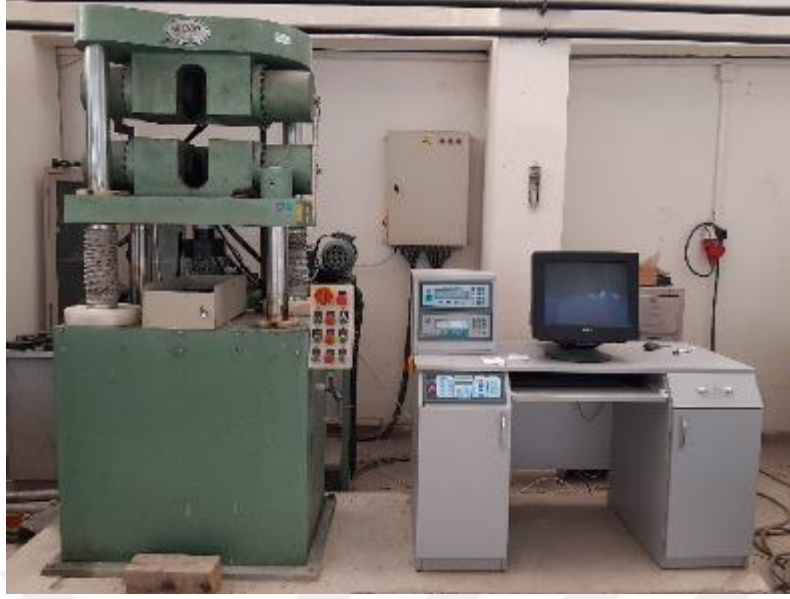
Şekil 10. Donatıların çekme deneyleri
