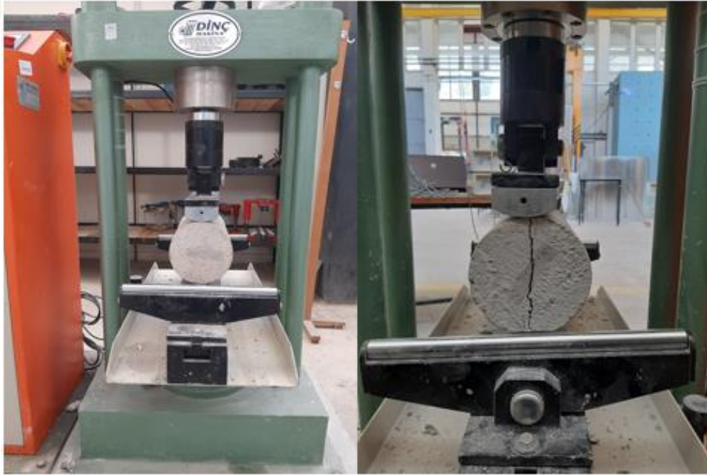
Şekil 12. Silindir beton numunelerin yarmada çekme deneyi
