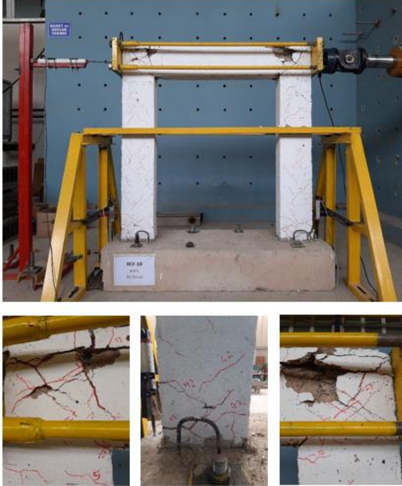
Şekil 59. Deney sonu RCF_10_800_60 deney elemanında oluşan hasar durumları
