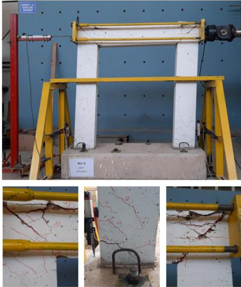
Şekil 80. Deney sonu RCF_9_600_180 deney elemanında oluşan hasar durumları
