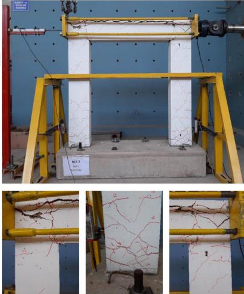
Şekil 56. Deney sonu RCF_7_600_60 deney elemanında oluşan hasar durumları
