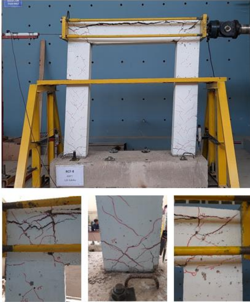
Şekil 68. Deney sonu RCF_8_600_120 deney elemanında oluşan hasar durumları
