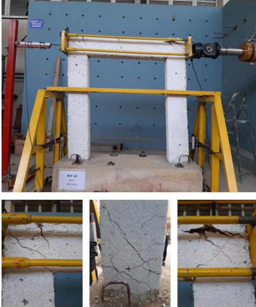
Şekil 83. Deney sonu RCF_12_800_180 deney elemanında oluşan hasar durumları
