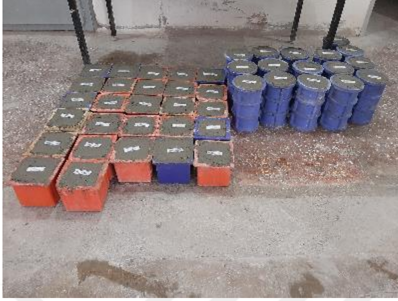
Şekil 15. Beton küp ve silindir numuneler
