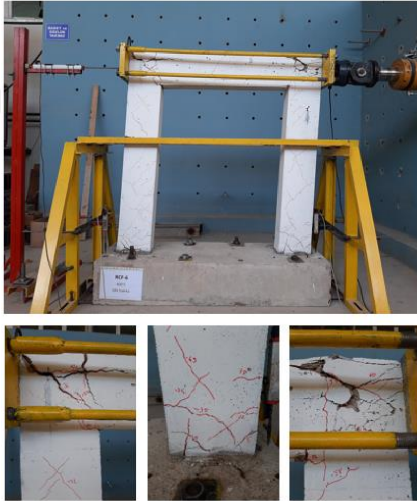
Şekil 77. Deney sonu RCF_6_400_180 deney elemanında oluşan hasar durumları
