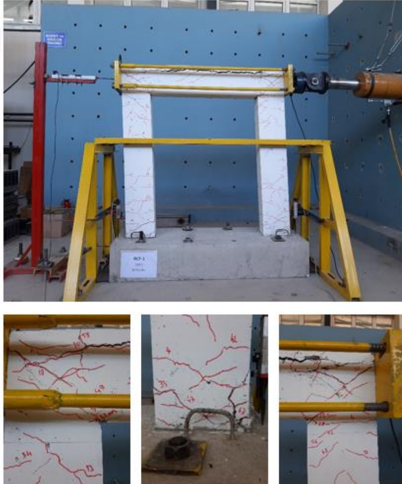
Şekil 50. Deney sonu RCF_1_200_60 deney elemanında oluşan hasar durumları
