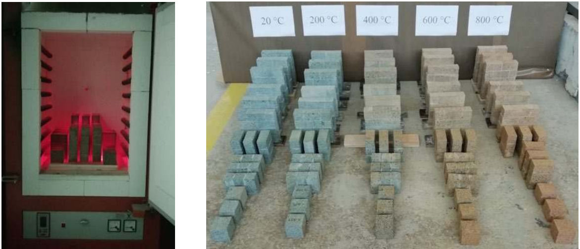
Şekil 2.19. Farklı sıcaklıklara maruz bırakılan duvar numuneleri
