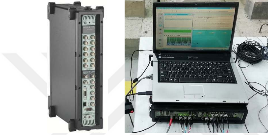
Şekil 1.38. Deneysel ölçümlerde kullanılan B&K 3560 C tipi 17 kanallı veri toplama ünitesi
