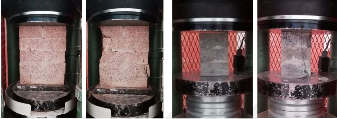
Şekil 2.20. Duvar numunelerinin i TS-EN 1051-1 (a) ve ASTM (b) standartlarına göre basınç dayanımlarının belirlenmesi
