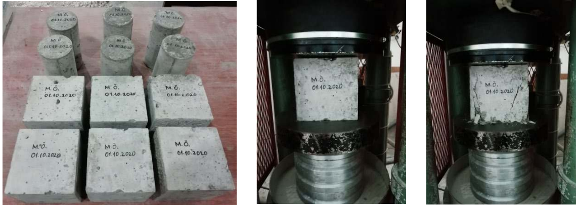
Şekil 2.12. Numunelerin malzeme özelliklerinin belirlenmesi amacıyla yapılan testlere ait bazı fotoğraflar
