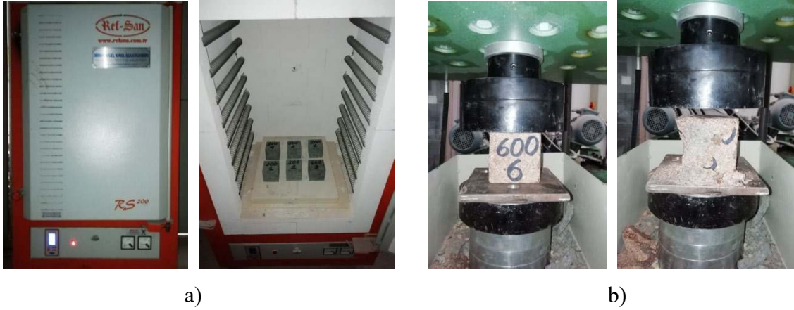
Şekil 2.15. Farklı sıcaklığa maruz bırakılan andezit taşının (a) basınç dayanımı testine (b) ait bazı fotoğraflar
