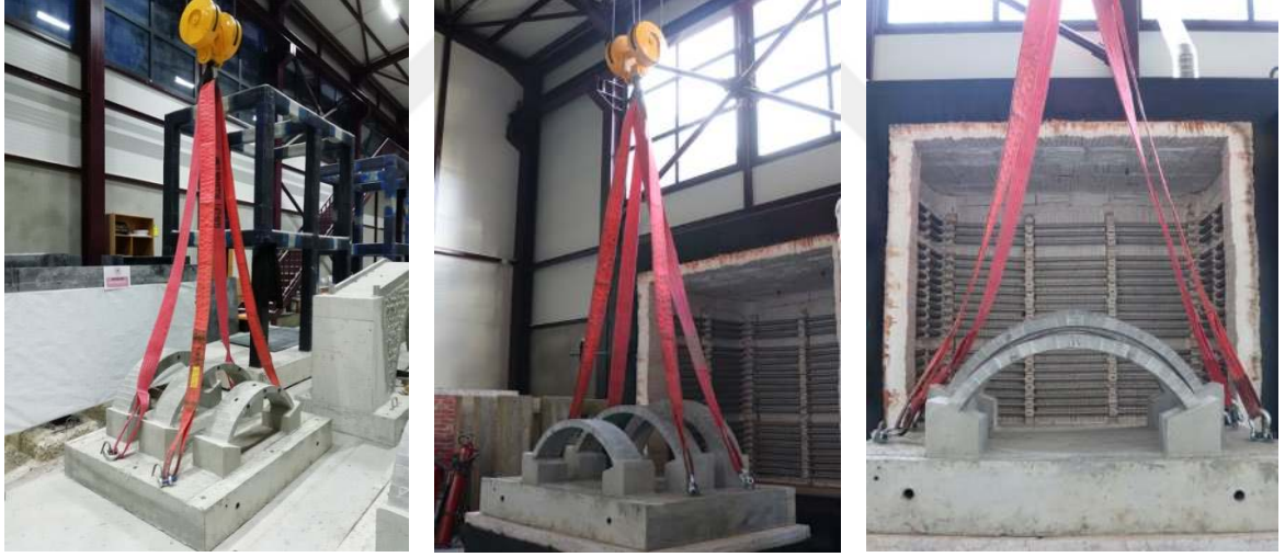
Şekil 2.31. Kemer modellerinin yüksek sıcaklık test fırınına taşınması
