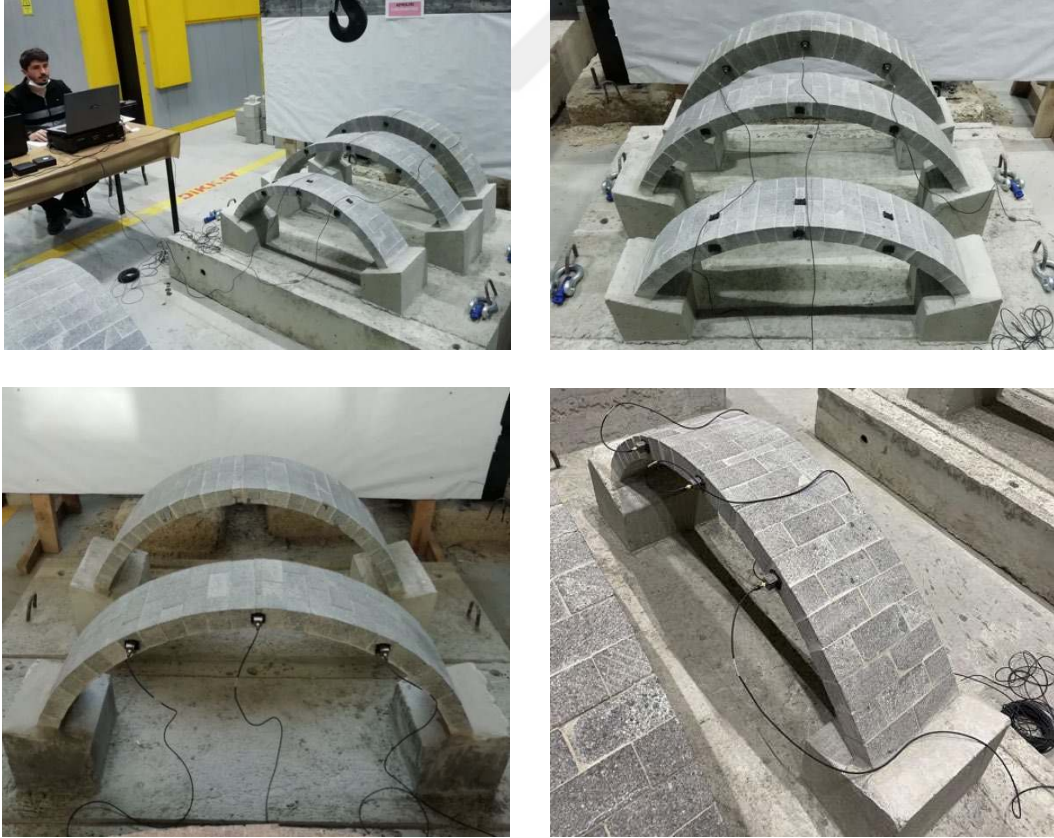
Şekil 2.21. Deneysel ölçümler için ivmeölçer bağlantı noktalarının hazırlanması
