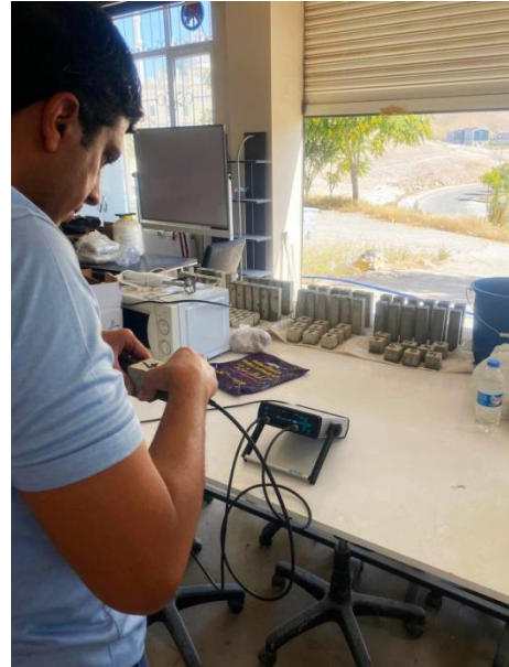
Şekil 3.11. UPV cihazı test cihazı ve düzeneği.
