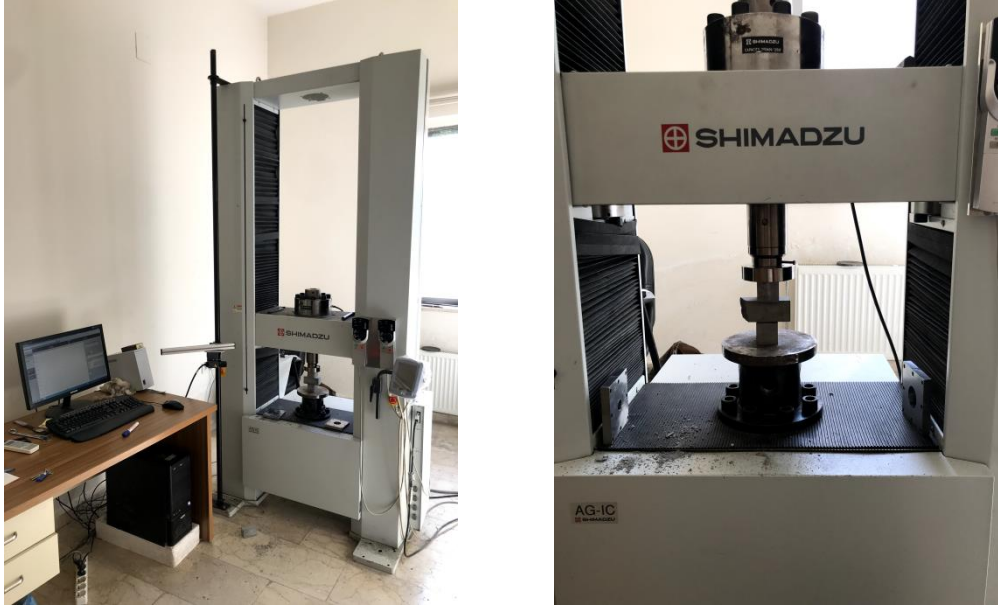
Şekil 3.10. Basınç dayanımı testi deney düzeneği.
