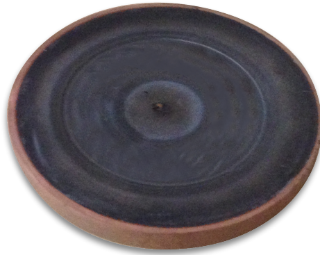
Şekil 3.21 Bakır kapsüle sıcak presle gömülmüş YBCO target.
