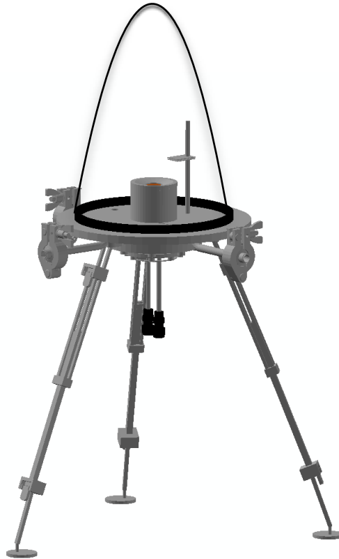
Şekil 3.26 Bell Jar tip magnetron sputter sistemi.
