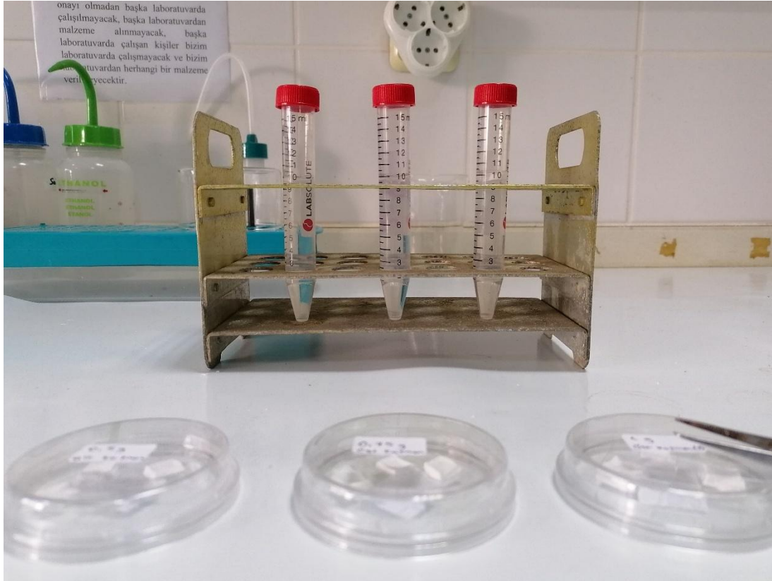
Şekil 5.7. Hidrojellerin şişme testlerinin gerçekleştirilmesi.
