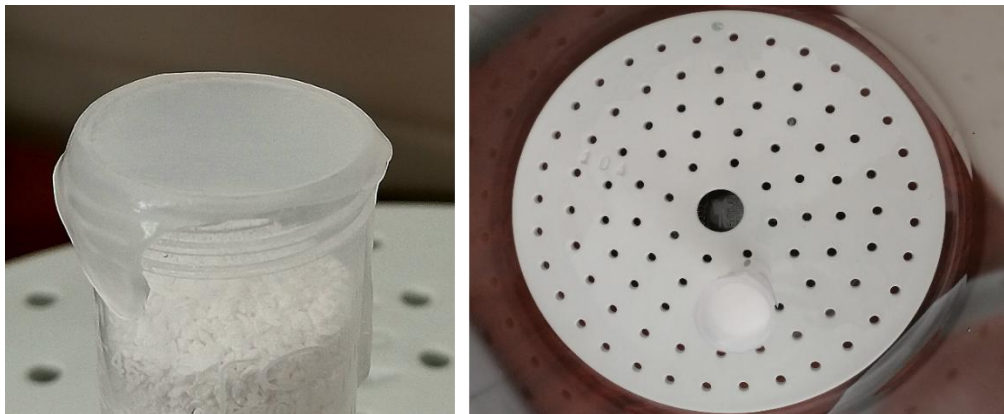
Şekil 5.8. Hidrojel membran ile kapatılmış Falcon tüpü (solda) ve su buharı geçirgenliği testi için kurulan desikatör düzeneğine yukarıdan bakış (sağda).
