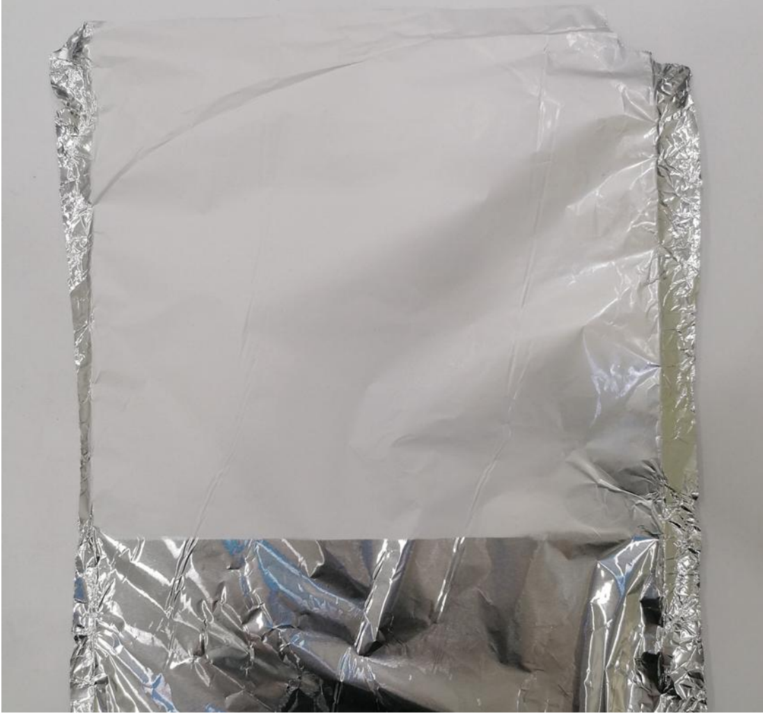
Şekil 5.3. Alüminyum folyo üzerine kaplanmış polimerik nanolif mat.
