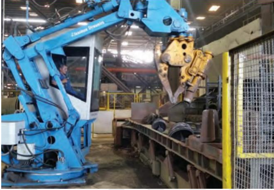
Şekil 2.5. Clansman Dynamics C620 model manipulatörün saha görüntüsü
