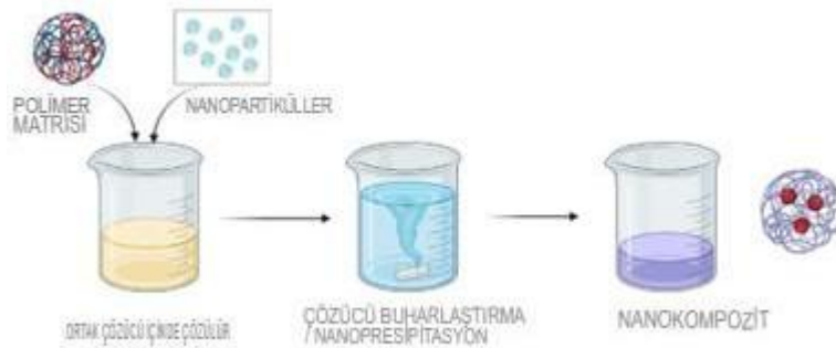
Şekil 19. Çözeltide harmanlama yöntemi (URL-11)
