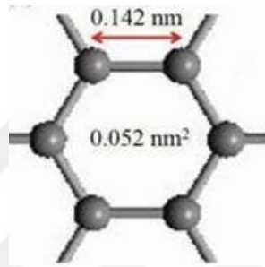
Şekil 16. Grafenin petek kristal yapısı (Meng & Chou,2015)
