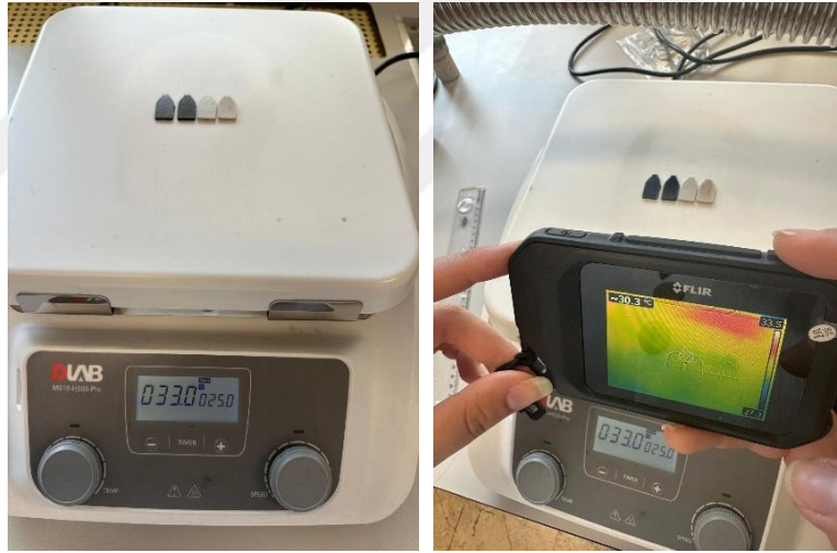
Şekil 25. Termal İletkenlik Ölçümü
