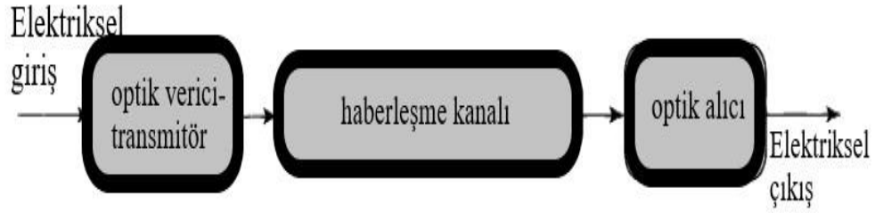
řekil 1.9. Optik bir iletiřim sisteminin genel blok diyagramını
