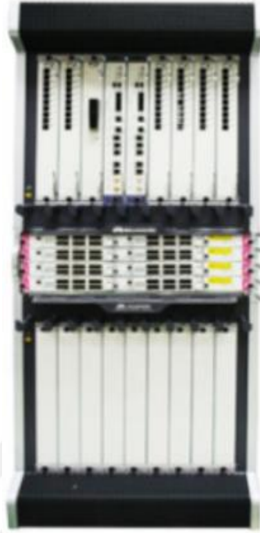
Şekil 3.13. Huawei marka router [72]
