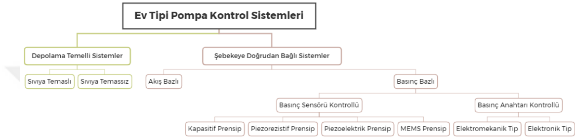
Şekil 2.3. Ev tipi pompa kontrol sistemlerinin sınıflandırılması
