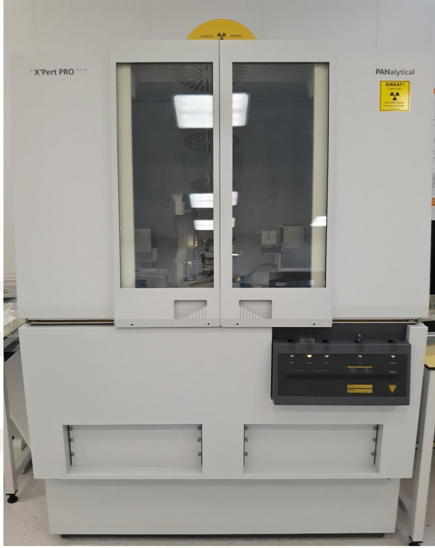
Görsel 3.3. Panalytical X'Pert Pro MRD yüksek çözünürlüklü X ışını kırınım cihazı, Nanoboyut Araştırma Laboratuvarı
