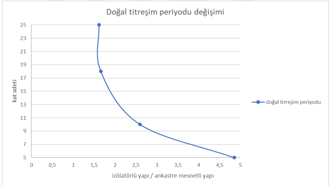
Şekil 49. Yapıların kat adedine bağlı doğal titreşim periyotlarının oranları (X yönü)
