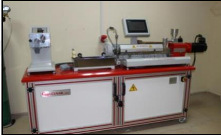
Şekil 3.2: Deneylerde kullanılan çift burgulu ekstrüder makinesi
