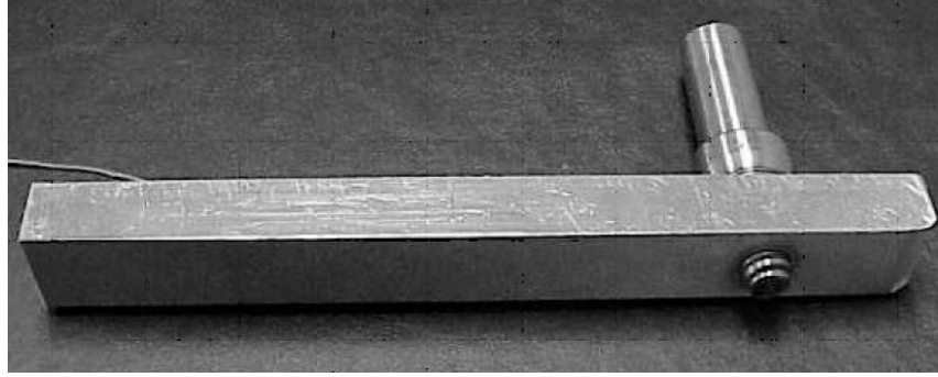
Şekil 5.3. Termoplastik polimerlerin SKK yöntemi ile birleştirilmesinde kullanılan ısıtıcı sistemli takım (Strand, 2003)
