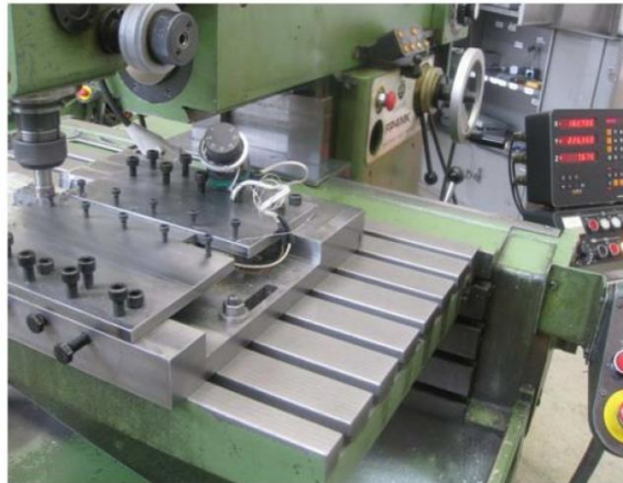
Şekil 5.9. HDPE malzemenin ısı destekli SKK prosesi
