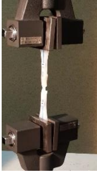
Şekil 7.13. Kaynak bağlantısının çekme testi
