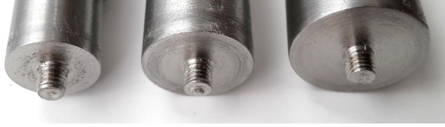
Şekil 7.3. 16, 20, 24 mm’lik omuz çapında üç farklı SKK takımı
