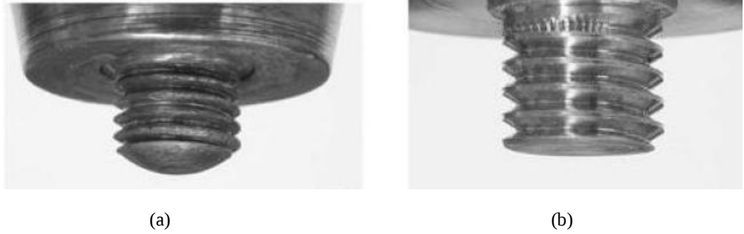
Şekil 4.29. SKK yönteminde kullanılan alıslmış silindirik pimli takımlara örnek (a) Küresel ağızlı silindirik pimli takım (b) Düz ağızlı silindirik pimli takım (Mishra and Ma, 2005)
