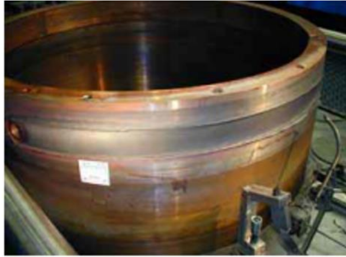
Şekil 4.51. Bakır korozyon bariyeri ve çelik iç yüzeye sahip yakıt muhafazası ve 5 cm kalınlığındaki bakır kapağın kesiti
