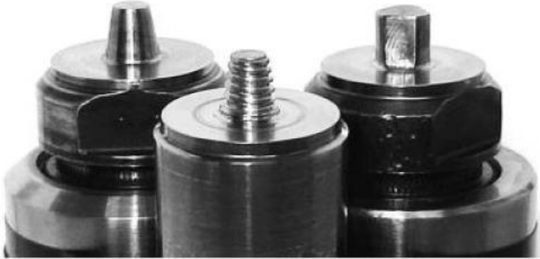
Şekil 4.28. SKK yönteminde kullanılan değişik tipteki takım tasarımları
