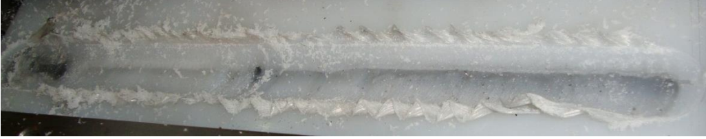
Şekil 8.18. HDPE malzemenin yanması, soyulması ve bozunması
