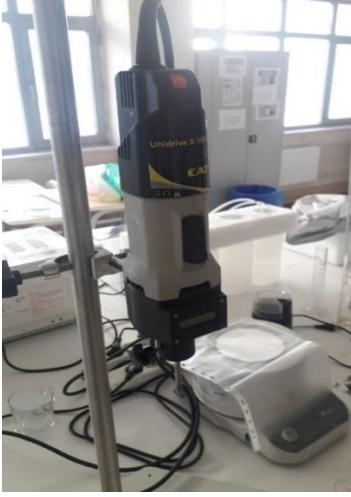
Resim 2.5. Kas dokularının homojenize edilmesinde kullanılan homojenizatör.
