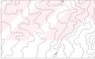
Şekil 3.19: Eşik açısı yöntemine göre ( \alpha=360 derece seçilerek) basitleştirilmiş (birinci alt veri kümesindeki) yükseklik eğrilerinin yumuşatılması ile elde edilen sonuç (Ölçek: 1 / 50 000)
