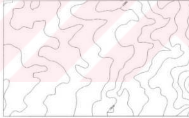
Şekil 3.14: Eşik mesafesi yöntemine göre ( d=85 metre seçilerek) basitleştirilmiş (birinci alt veri kümesindeki) yükseklik eğrilerinin yumuşatılması ile elde edilen sonuç (Ölçek: 1 / 50 000)
