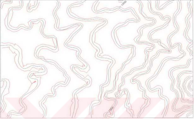
Şekil 3.10: n. nokta yöntemine göre ( n=3 seçilerek) genelleştirilmiş (birinci alt veri kümesindeki) yükseklik eğrileri ve hata bantları (Ölçek: 1 / 25 000)
