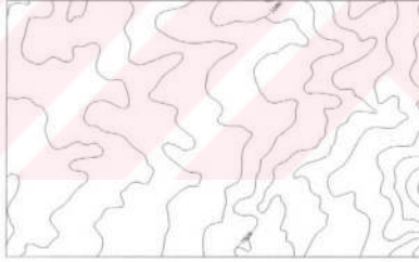
Şekil 5.5: n . ve karakteristik nokta yöntemine göre ( n=3 seçilerek) basitleştirilmiş (üçüncü alt veri kümesindeki) yükseklik eğrilerinin yumuşatılması ile elde edilen sonuç (Ölçek: 1 / 50 000)
