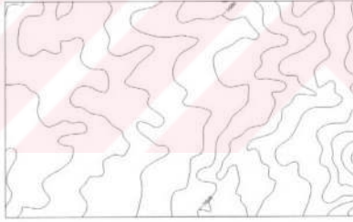
Şekil 3.9: n. nokta yöntemine göre ( n=3 seçilerek) basitleştirilmiş (birinci alt veri kümesindeki) yükseklik eğrilerinin yumuşatılması ile elde edilen sonuç (Ölçek: 1 / 50 000)
