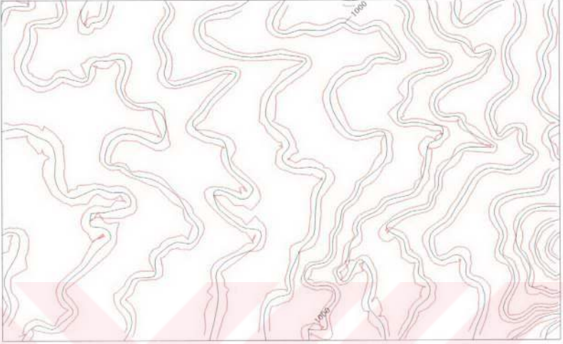
Şekil 3.15: Eşik mesafesi yöntemine göre ( d=85 metre seçilerek) genelleştirilmiş (birinci alt veri kümesindeki) yükseklik eğrileri ve hata bantları (Ölçek: 1 / 25 000)
