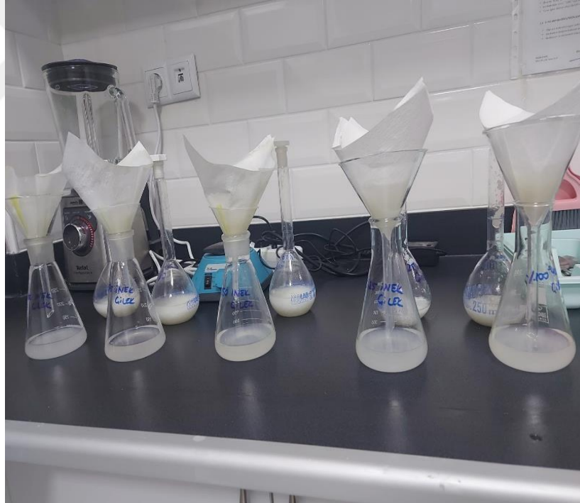
Şekil 4.9. Şeker tayininde durultma ve filtrasyon işlemi
