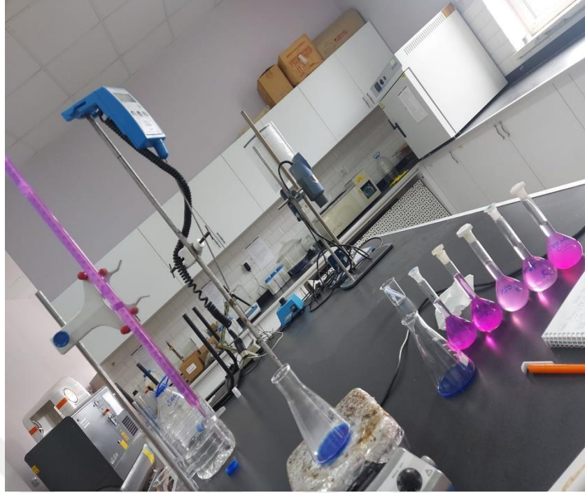
Şekil 4.10. Şeker tayininde titrasyon işlemi
