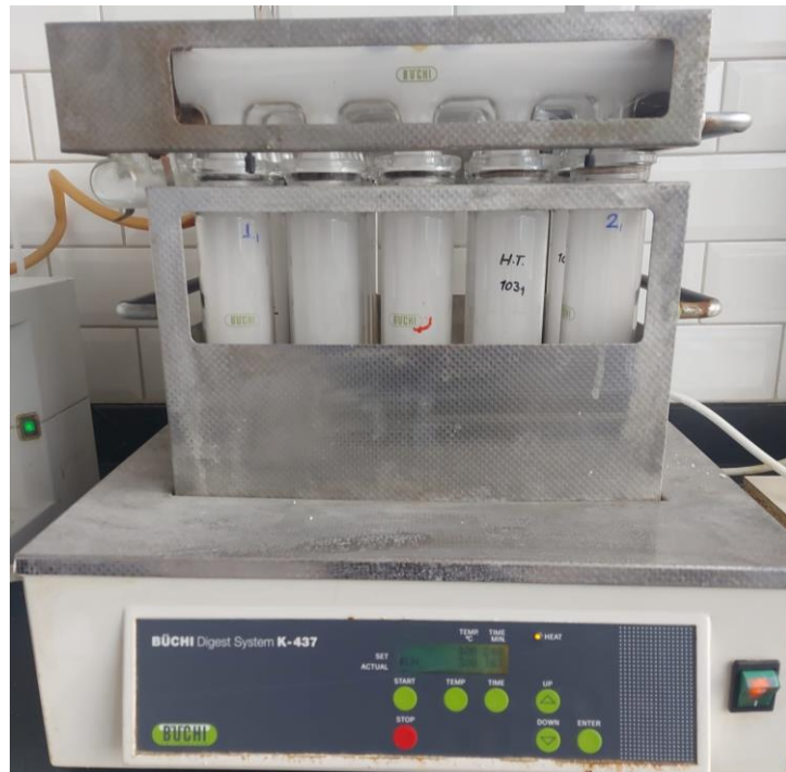
Şekil 4.7. Protein tayininde yakma işlemi
