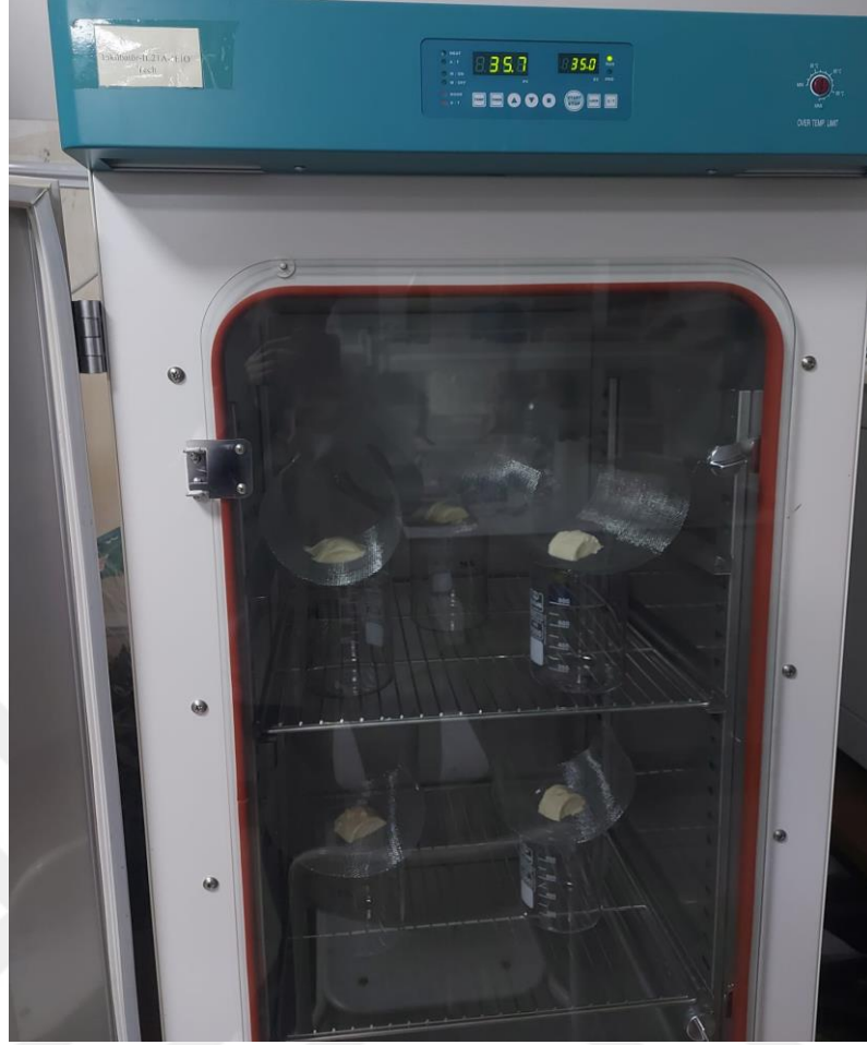
Şekil 4.12. Dondurma örneklerinin erime özelliklerinin tespiti
