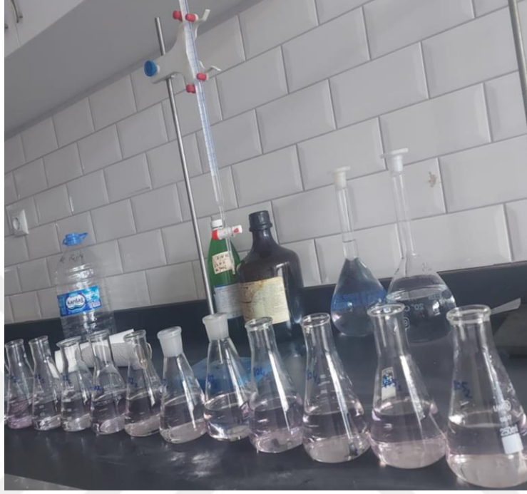
Şekil 4.8. Protein tayininde titrasyon işlemi
