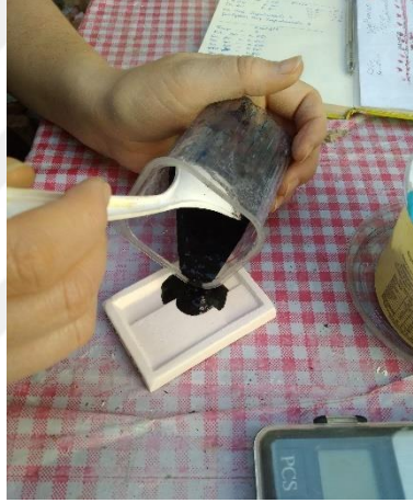
Görsel 5.6. Karışımların deneme plakalarının üzerinde uygulanması (Ereshova, 2020)
