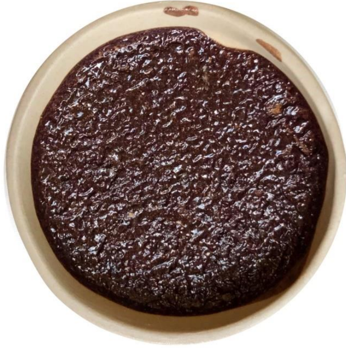
Görsel 5.20. Uygulama 12, Turp Külü %60 Karışım %40 + %2 \text{Fe}_2\text{O}_3 , 9 x 9 x 2cm, 1200°C, 2020 (Ereshova, 2020)
