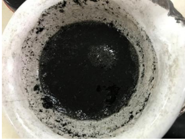
Görsel 5.5. Şalgam külü ve üleksit karışımının porselen havanda öğütülmesi (Ereshova, 2019)
