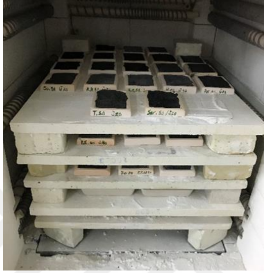
Görsel 5.8. Seramik fırınında deneme plakalarının 1200°C sıcaklıkta pişirimi (Ereshova, 2019)
