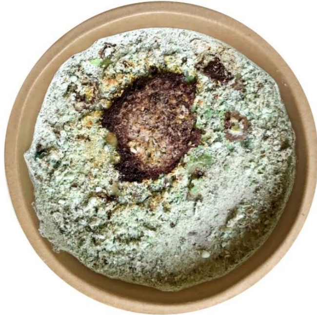
Görsel 5.19. Uygulama 11, Sarımsak Külü %60 Saydam Frit %40 + %1 \text{Cr}_2\text{O}_3 , 9 x 9 x 2cm, 1200°C, 2020 (Ereshova, 2020)
