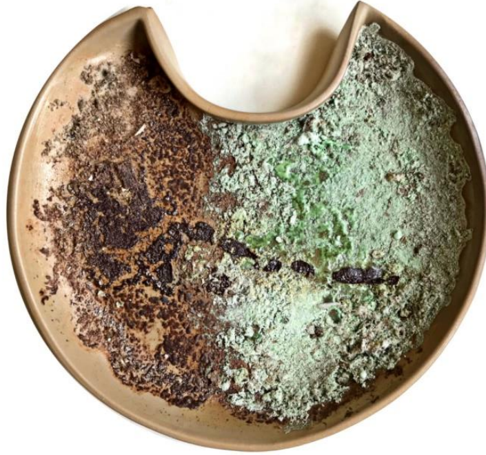
Görsel 5.9. Uygulama 1, Kereviz Külü %60 Sarımsak Külü - %40 Saydam Frit + %1 \text{Cr}_2\text{O}_3 , 25 x 25 x 3cm, 1200°C, 2020
