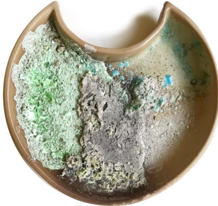
Görsel 5.15. Uygulama 7, %60 Şeker Pancarı Külü - %40 Saydam Frit + %3 \text{CuO} , %60 Soğan Külü - %40 Karışım + %1 \text{Cr}_2\text{O}_3 , 18 x 18 x 3cm, 1200°C, 2020 (Ereshova, 2020)
