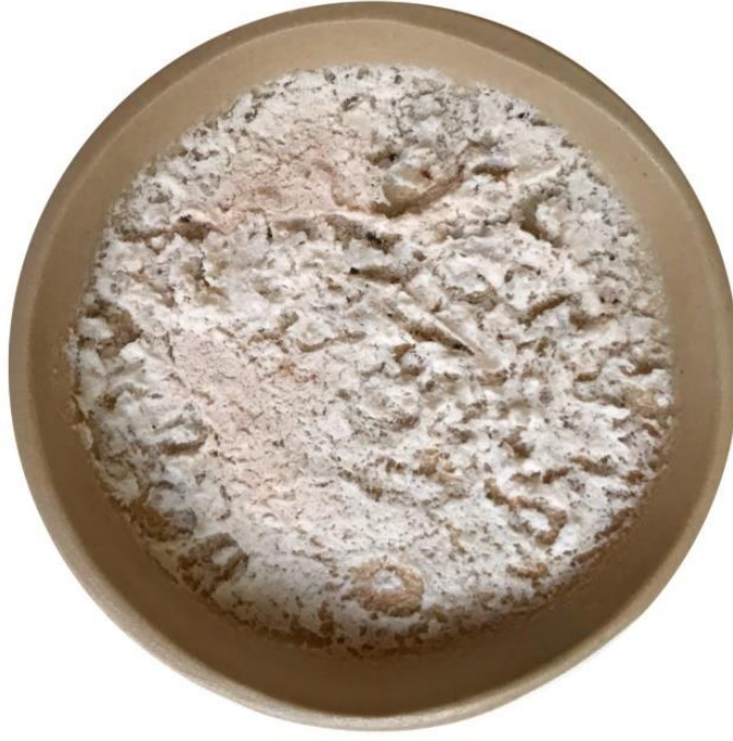
Görsel 5.16. Uygulama 8, Şalgam Külü %60 Potasyum Feldspat %40, 9 x 9 x 2cm, 1200°C, 2020 (Ereshova, 2020)
