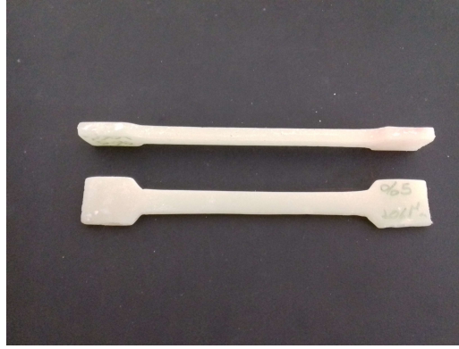
Şekil 3. 12. Çekme testi için üretilen kompozit numune
