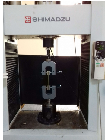
Şekil 3. 13. Üniversal çekme cihazı ve bağlanmış numune
