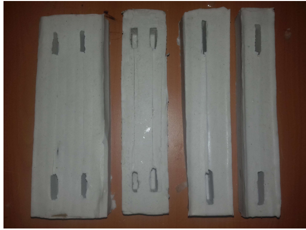
Şekil 3. 8. RTV 2 silikon kalıpları
