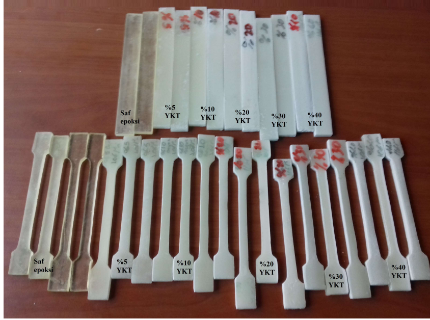
Şekil 3. 10. Çekme ve üç nokta eğilme deneyleri için üretilen bazı numuneler
