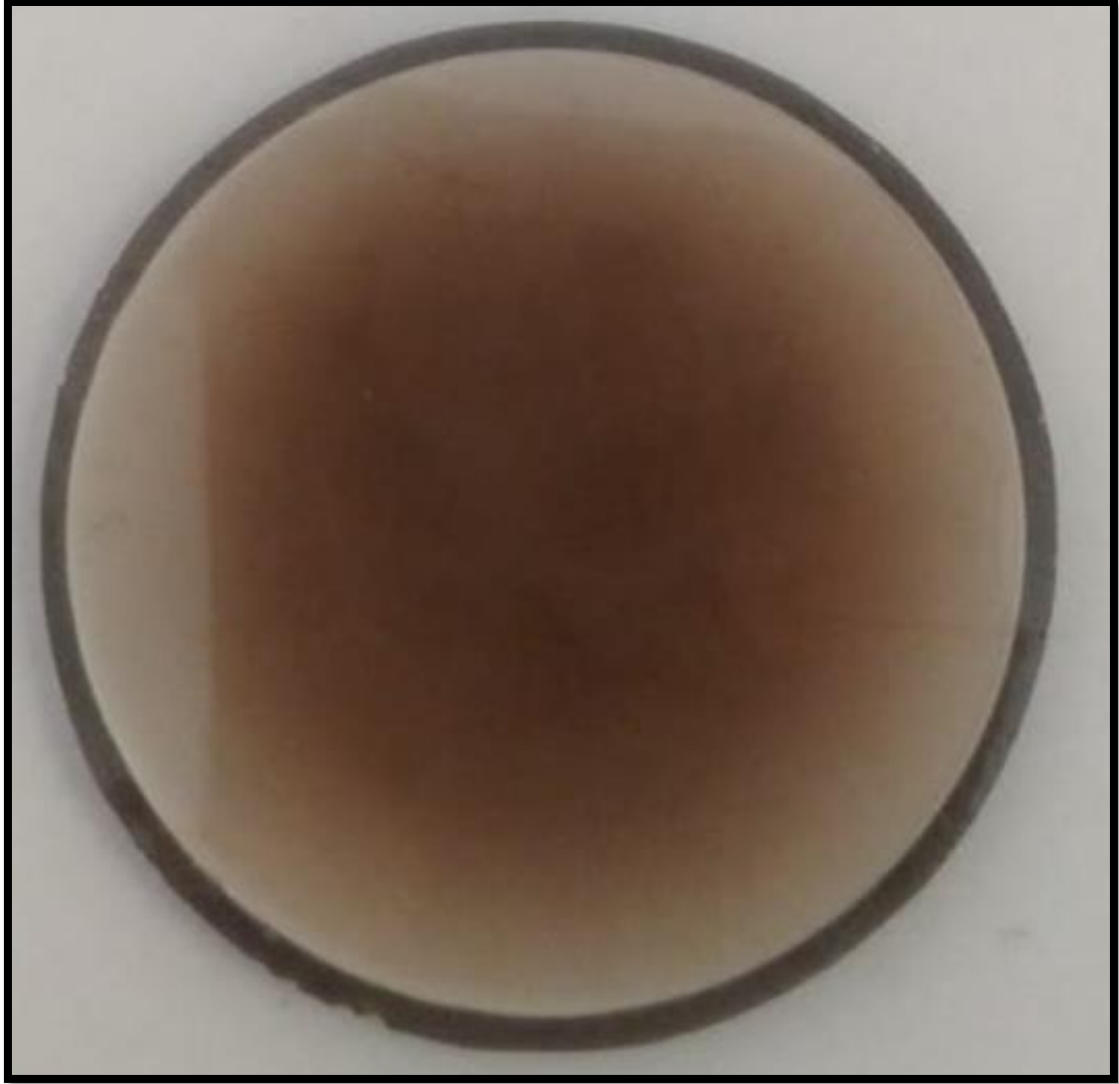
Resim 4.1 Elektrik İndüksiyonlu Eritiř Cihazında řahit numuneden hazırlanmıř cam eritiř numunesi. (Cam eritiř numunesi, X Ray Cihazında analiz yapılırken, kasetin penceresinden numuneye arpan X ıřınları, cam numuneyi yakarak rengini koyulařtırmaktadır.)
