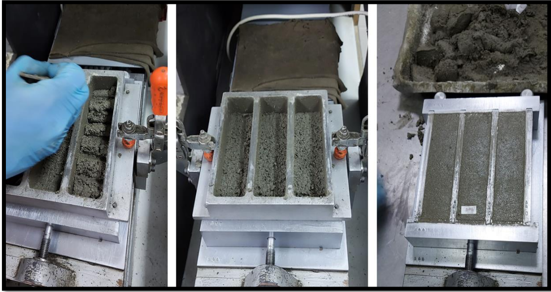
Resim 4.6 Sarsma cihazında harcın yarısı kalıba yerleştirilirken (solda). Harcın tamamı kalıba yerleştirilip ikinci 60 saniye vuruştan sonra (ortada). Kalıp yüzeyi master ile sıyrılıp harç yüzeyi düzleştirildikten sonra (sağda).
