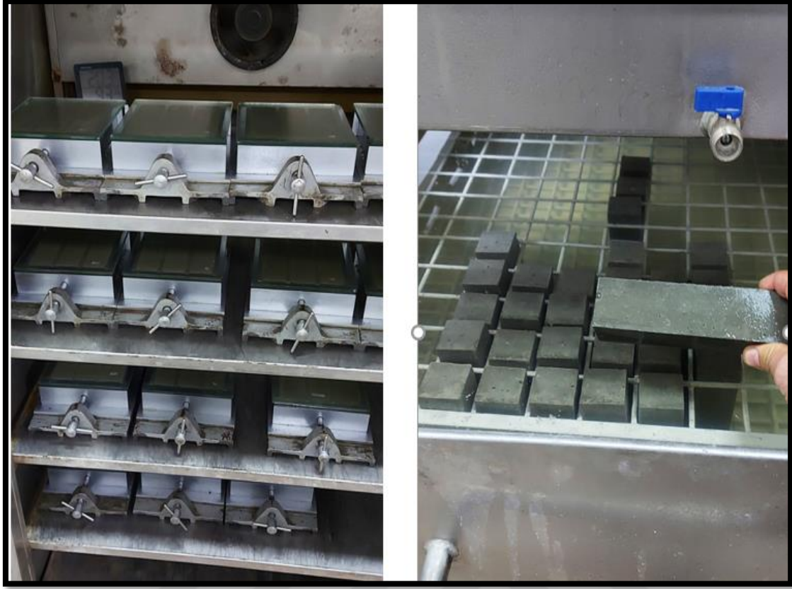
Resim 4.7 Cam plaka ile üzeri kapatılıp, krleme dolabına yerleřtirilen prizma kalıpları (solda). Kalıptan ıkarılan prizma beton numuneleri (saėda).
