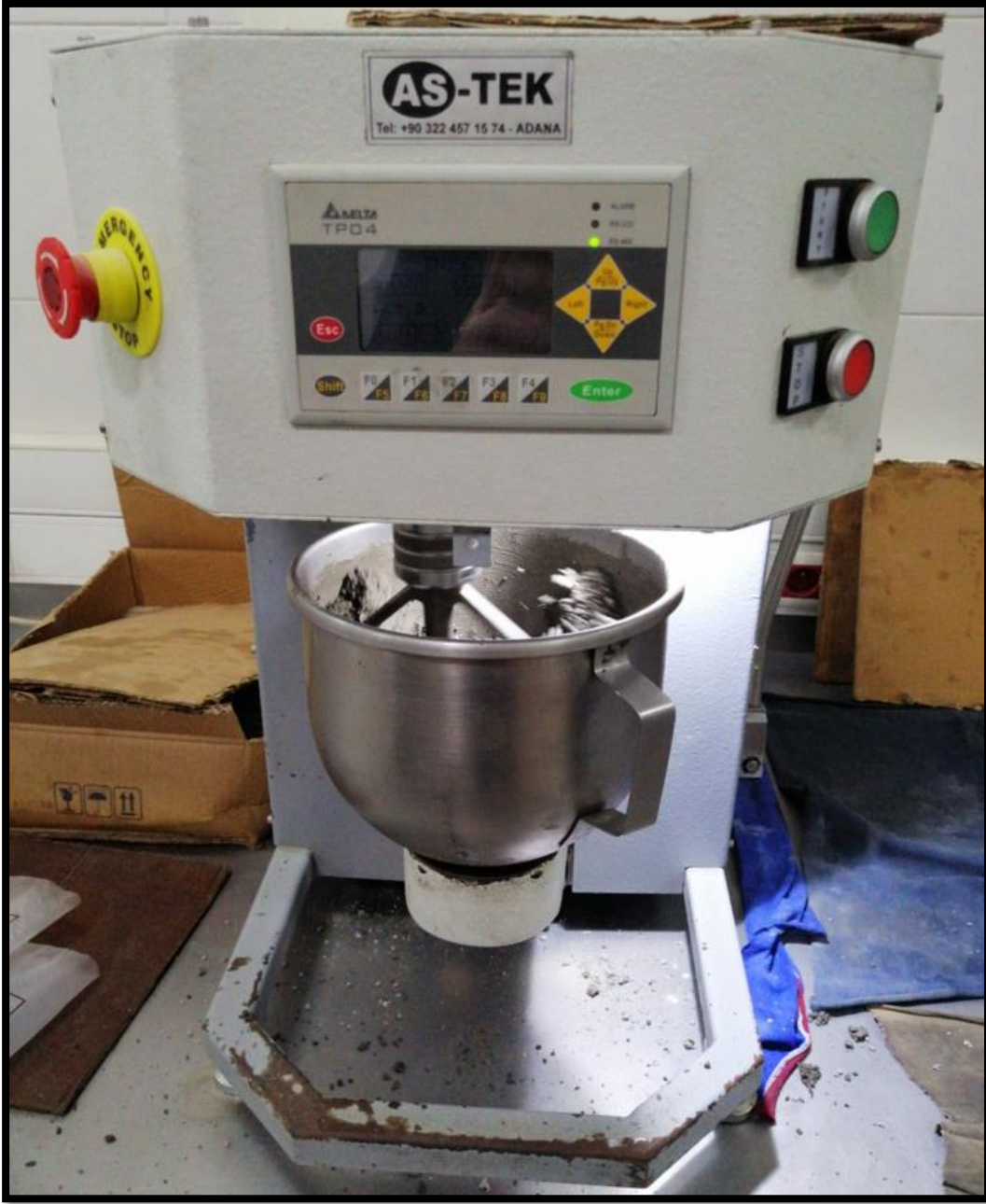
Resim 4.5 Astek marka Otomatik Harç Karıştırma Cihazında harç hazırlanırken.
