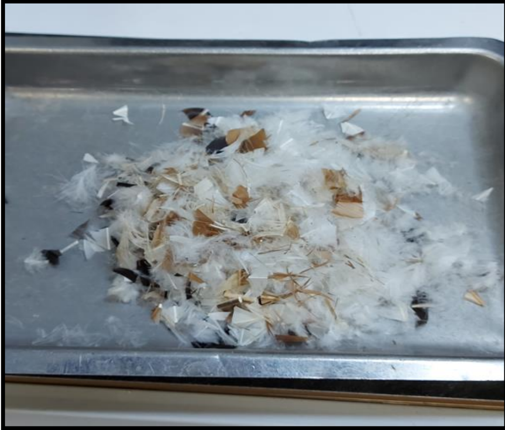
Resim 3.9 Kırpılıp, asetonla yıkandıktan sonra etüvde kurutulmuş tavuk tüyleri.
