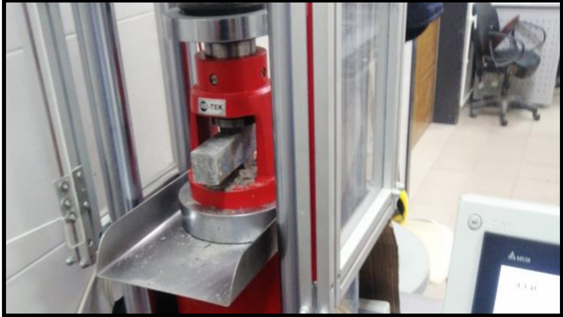
Resim 4.8 Basın dayanım test cihazında prizmalar kırılıp, basın dayanımları llrken.
