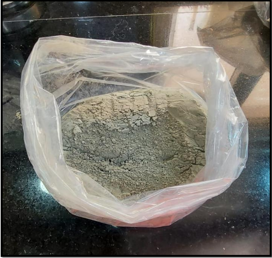
Resim 3.1 Laboratuvar değirmeninde hazırlanan şahit numune (katkısız çimento numunesi).
