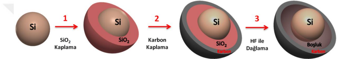
Şekil 5.2. Yumurta-Kabuk morfolojili silisyum partiküllerinin üretim aşamalarının şematik olarak gösterimi.
