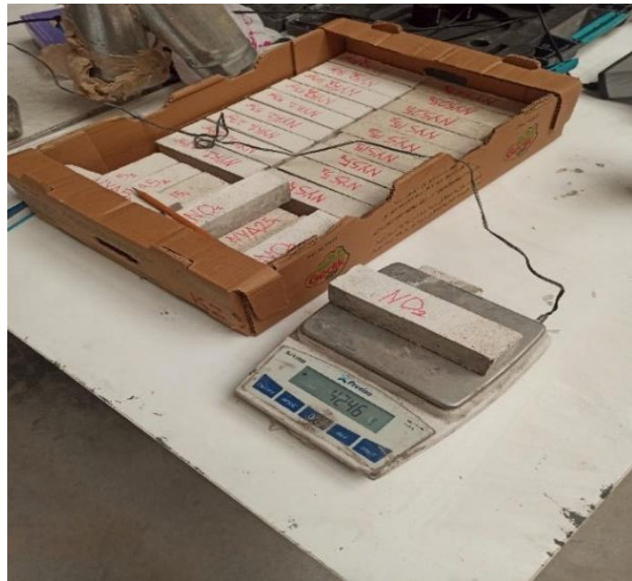
Şekil 3.12. Numunelerin kuru birim hacim ağırlık ölçümü.
