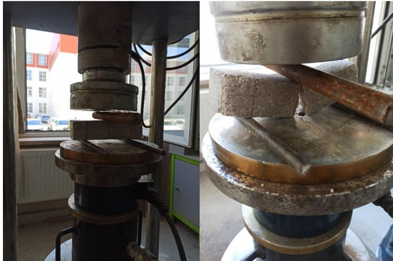
Şekil 3.14. Eğilmede çekme dayanımı deneyi.
