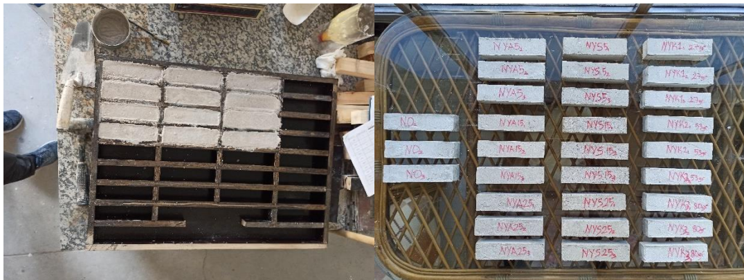
Şekil 3.9. Harç kalıpları ve numunelerin uygun ortamda bekletilmesi.
