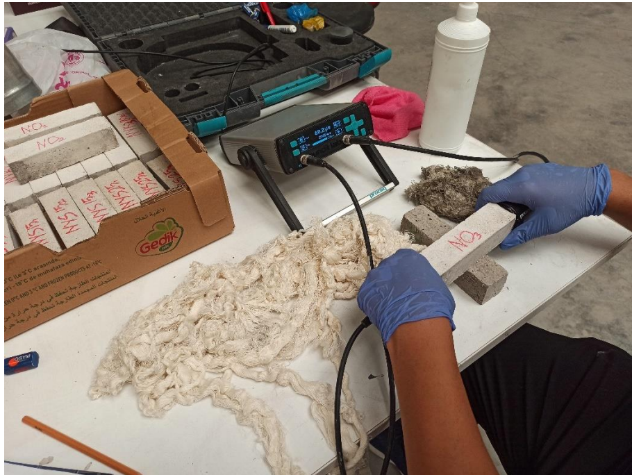
řekil 3.13. Ultrases deneyi yapıımı.
