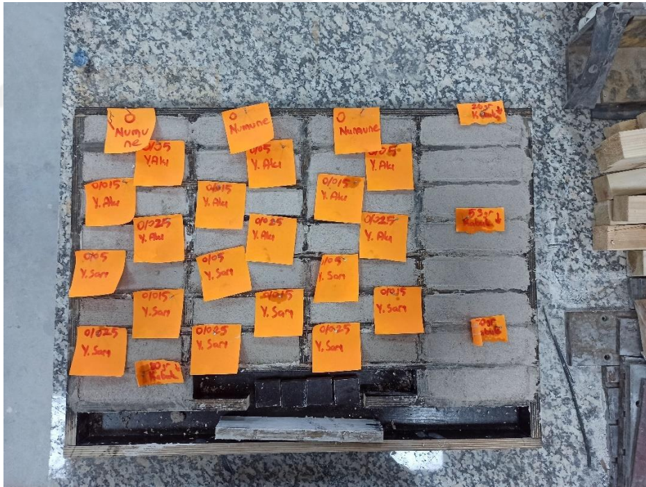
Şekil 3.10. Yerleştirilen harç numuneleri ve katkı oranları.
