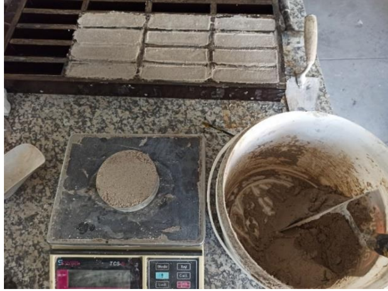
Şekil 3.11. Numunelerin taze birim hacim ağırlık ölçümü.
