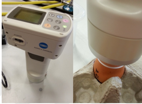
Şekil 3.8. Yumurtanın kabuk renklerinin ölçülmesi
