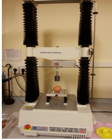
Şekil 3.13. Yumurtanın tekstür analizi
