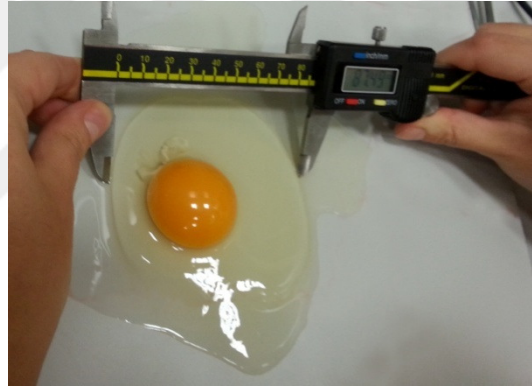
Şekil 3.9. Yumurtanın ak genişliğinin ölçümü
