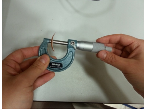
Şekil 3.7. Yumurtanın kabuk kalınlığının ölçülmesi
