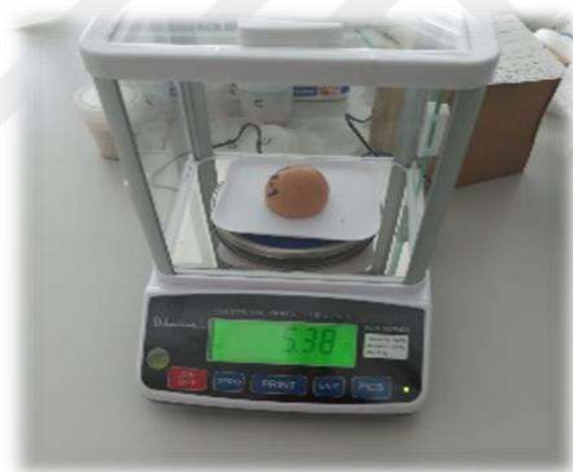
Şekil 3.7. Yumurta kabuk oranının belirlenmesi
