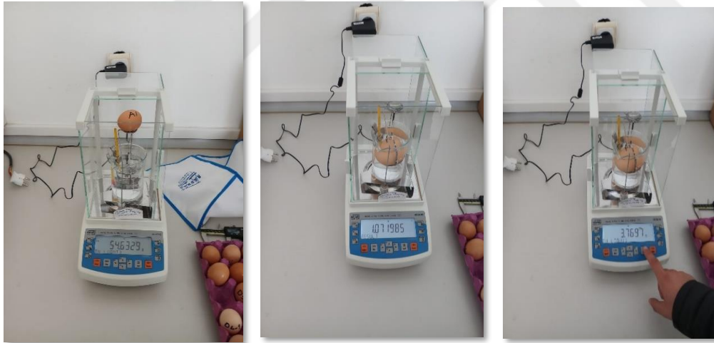
Şekil 3.5. Yumurta özgül ağırlığının tespiti
