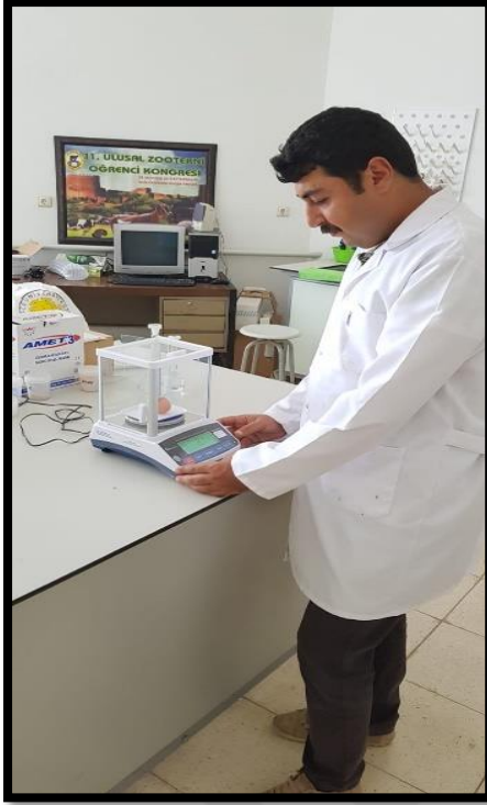
Şekil 3.8. Hassas Elektronik Terazi ile Yumurta Kabuğunun Ölçümü
