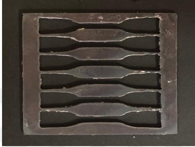
Resim 16. ASTM D 638-14 standartlarına uygun boyutlarda örnek elde etmek için hazırlanan paslanmaz çelik kalıp
