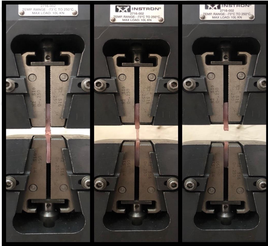
Resim 23. Çekme bağlantı dayanımı testinin uygulanması
