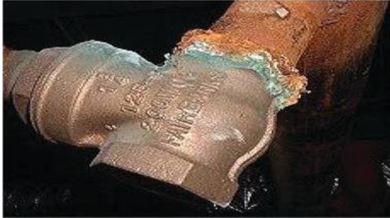
Şekil 1.14. Galvanik korozyon şematik gösterimi.
