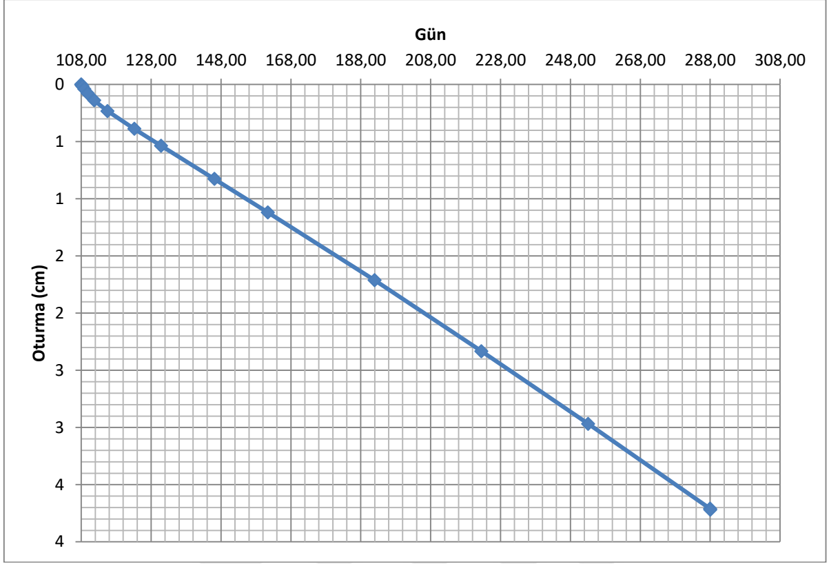
Şekil 5.7 Delme Kazık Yapıldıktan Sonra Zamana Bağlı Oturmalar.
