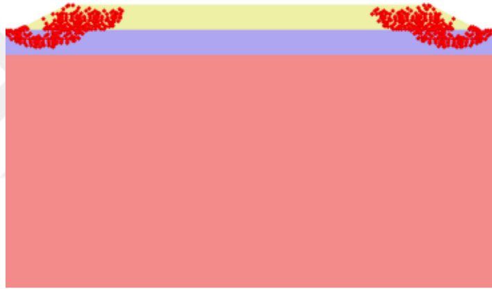
Şekil 5.27. 2 m yumuşak tabaka için plastik yüklemeye ait göçme durumunu gösteren plastik noktalar
