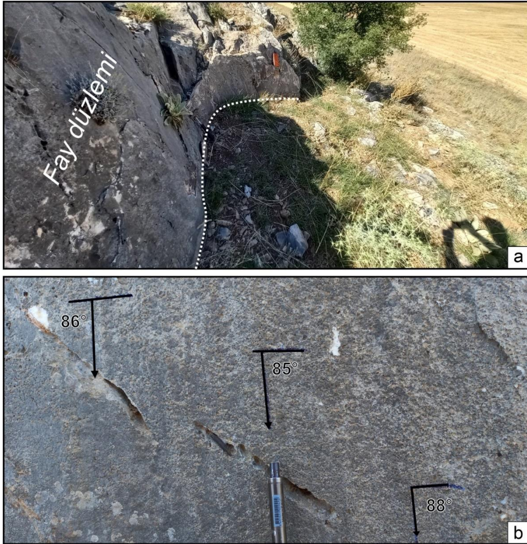
Şekil 3.14 L-4'e ait fay düzlemi ve fay çizikleri içeren arazi fotoğrafları.
