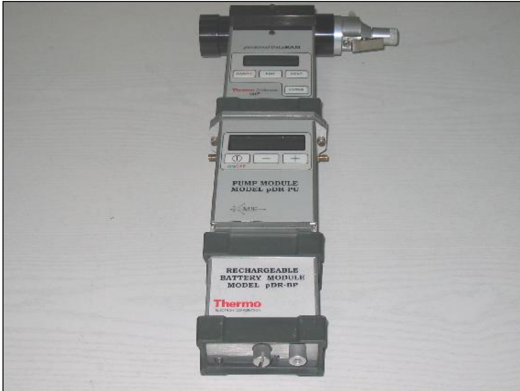
Şekil 3.1. Thermo Anderson Emisyon Ölçüm Cihazı
