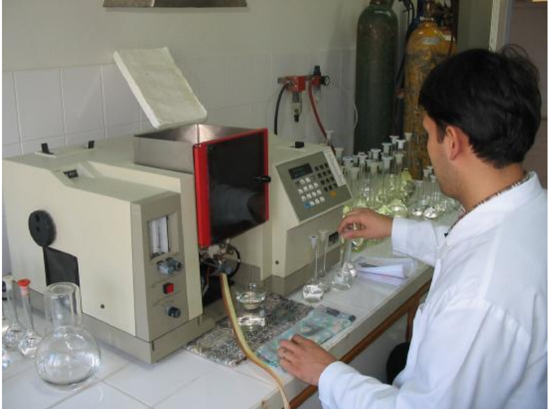
Şekil 3.5. Toz Çözeltilerinin Atomik Absorbsiyonda Okunması
