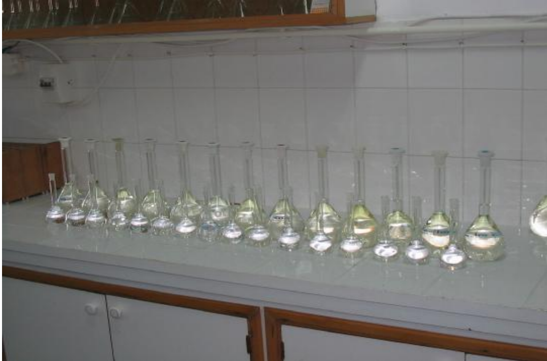
Şekil.3.4. Kimya Laboratuvarında Çözelti Haline Getirilen Toz Örnekleri
