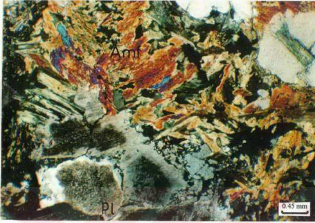
Şekil 3.19. Demirkent plütunun diyorit pegmatitlerinde gözlenen kümülofirik doku, Çift Nikol, Kesit no: 515 (Pl: plajiyoklas, Amf: amfibol)
