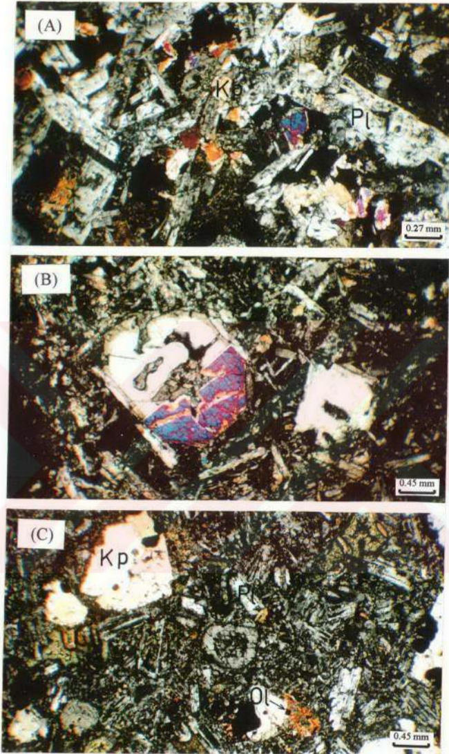
Şekil 3.27. Kınalıçam volkanik karmaşığı dolerit ve bazaltlarında gözlenen dokular, Çift Nikol (A: doleritlerin ofitik dokusu, Örnek no: 10, Morkaya güneyi; B: bazaltlardaki klinopiroksenlerde gelişen koy yapısı ve mikrolitik hamur, Kesit no: 771, Legvan Dağı kuzeyi; C: bazaltlardaki plajiyoklasda gelişen süzgeç dokusu ve iddingsite dönüşen olivinler, Örnek no: 302, Kırğülü; Pl: plajiyoklas; Kp: klinopiroksen; Ol: olivin)
