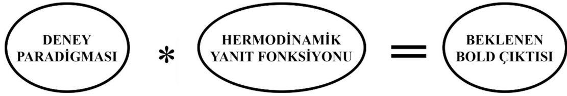
Şekil 3.8. Çıkışta oluşması beklenen BOLD sinyaline ait işlem diyagramı
