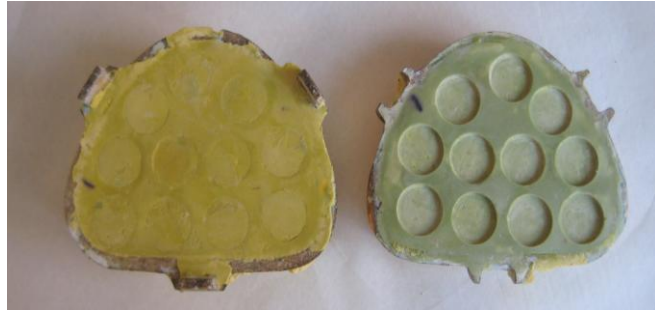
Resim 14: Piring muflada mum eritildikten sonra oluşan alçı kalıp
