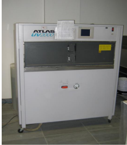
Resim 25: Atlas UV2000 Hızlandırılmış Hava Koşullandırma Test Cihazı
