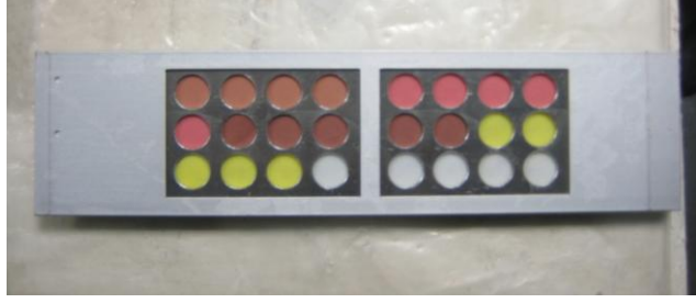
Resim 24: Alüminyum kalıp içindeki silikon örnekler
