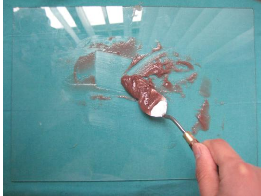
Resim 15: Hassas tartı Resim 16: Siman camında silikonun karıştırılması
