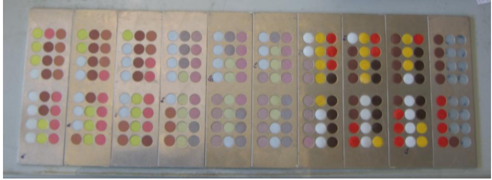
Resim 22: Kalıplara yerleřtirilen silikon rnekler
