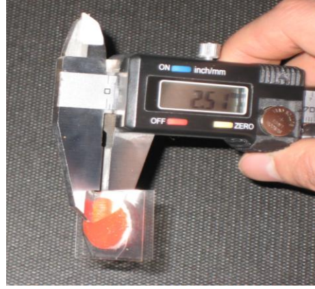
Resim 19: Digital kalınlık ölçer ile silikon örneklerin ölçülmesi
