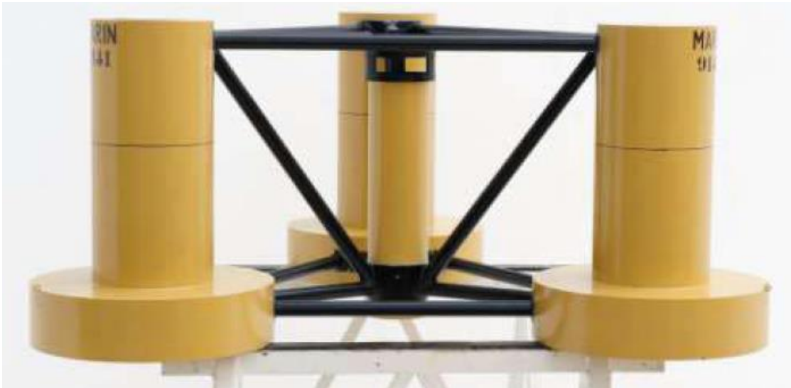
Şekil 106. OC-4 DeepCwind yarı-batık platformu 1:50 test ölçeği modeli [212].
