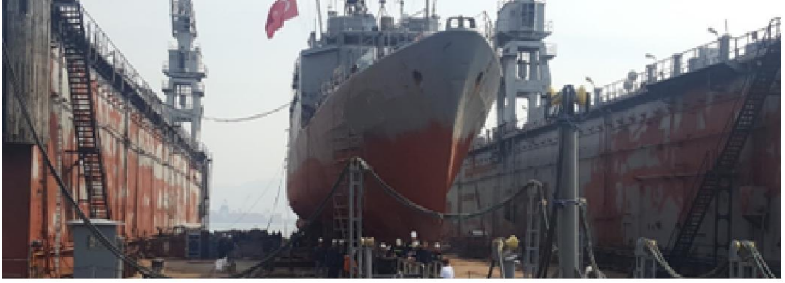
Şekil 2.9 Geminin Yüzer Havuzda Kuruya Çıkmış Görseli (Kişisel Arşiv)
