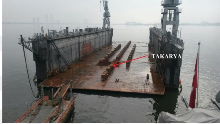
Şekil 2.3 Yüzer Havuzun Takarya Dizilmiş Durumu (Kişisel Arşiv)
