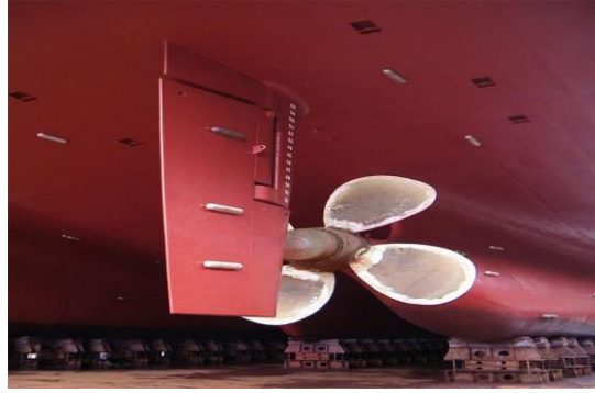
Şekil 2.18 Gemi Karinasında Bulunan Tutyalar (Submarin Anode, 2020, https://sub-marin.com.tr )
