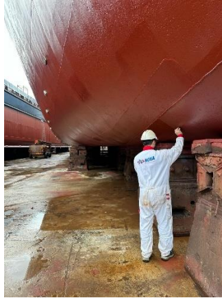
řekil 2.14 Gemi Karinasının Ultrasonik Sac Kalınlık lm (Nova NDT& Engineering, 2024, https://novandt.com/ )
