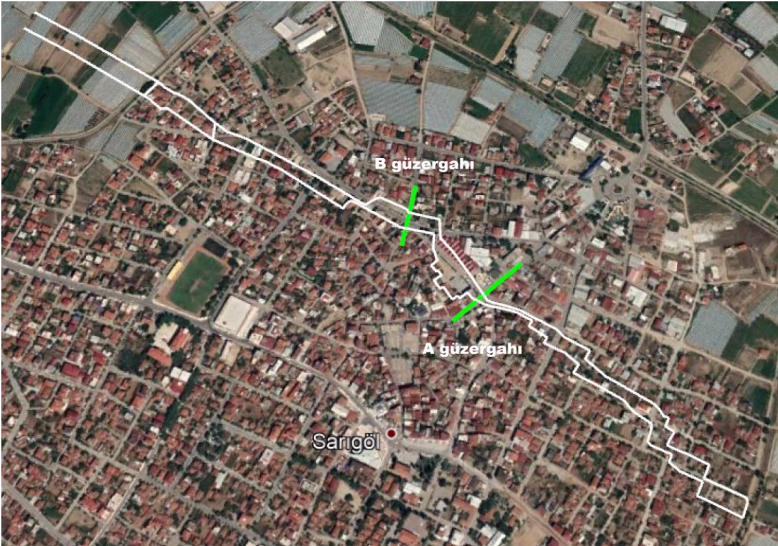
Şekil 4.5 Sarıgöl fay hattı ve güzergahlar (Beyaz çizgiler yerleşime riskli alanı Yeşil çizgiler güzergahları göstermektedir).
