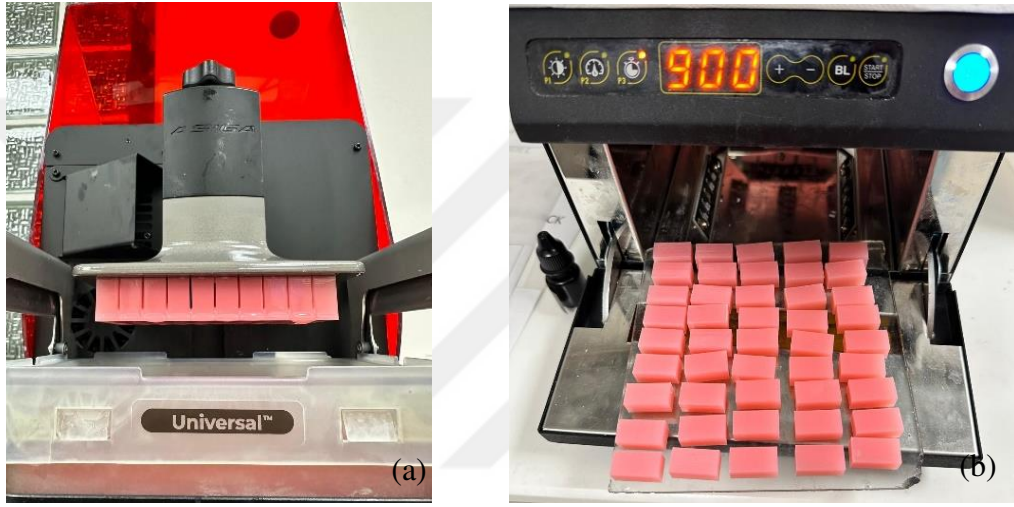
Resim 3. Kaide plağı örneklerinin üç boyutlu yazıcıda üretilmesi(a), Kaide plağı örneklerine post-polimerizasyon işlemi uygulanması(b)
