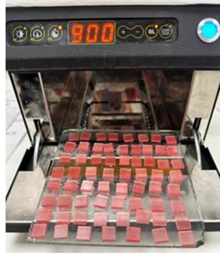
Resim 4. Deneysel yumuşak astar materyali örneklerinin üç boyutlu yazıcıda üretilmesi (a), Deneysel yumuşak astar materyali örneklerine post-polimerizasyon işleminin uygulanması (b)
