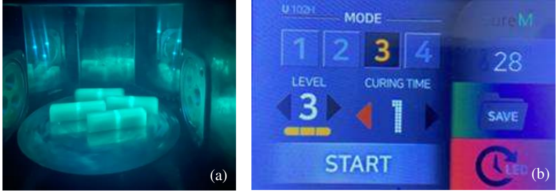
Resim 13. Üç boyutlu yazıcı ile üretilmiş kaide plağı örneklerinin ve deneysel yumuşak astar materyallerinin birbirine bağlanması (a) ve parametre değerleri (b)
