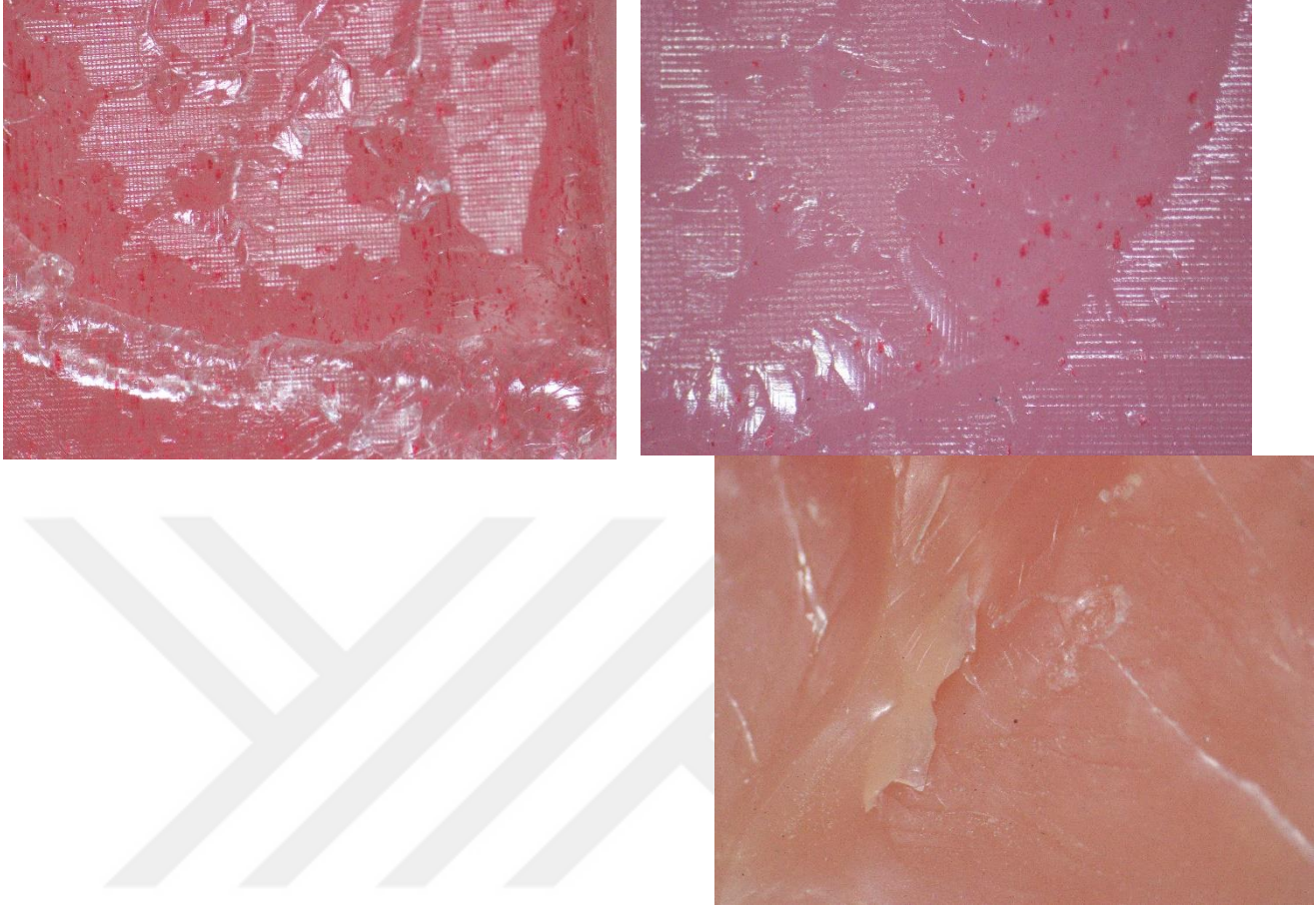
Resim 31. X20 büyütme altında koheziv kopma tipinin görüldüğü yumuşak astar materyali yüzeyi
