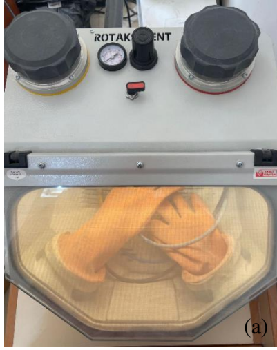
Resim 9. Çalışmada kullanılan kumlama cihazı ve 110 \mu\text{m} \text{Al}_2\text{O}_3 kumu
