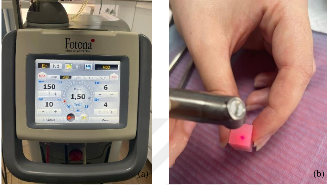
Resim 11. Lazer yüzey işleminde kullanılan Er;YAG lazer ve parametre değerleri (a), Örneklerle Er:YAG lazer uygulaması(b)
