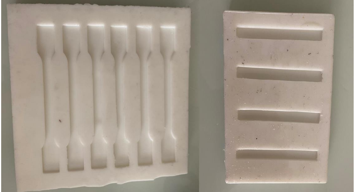
řekil 4.6. Çekme test çubuęu ve eğme test çubuęu kalıpları
