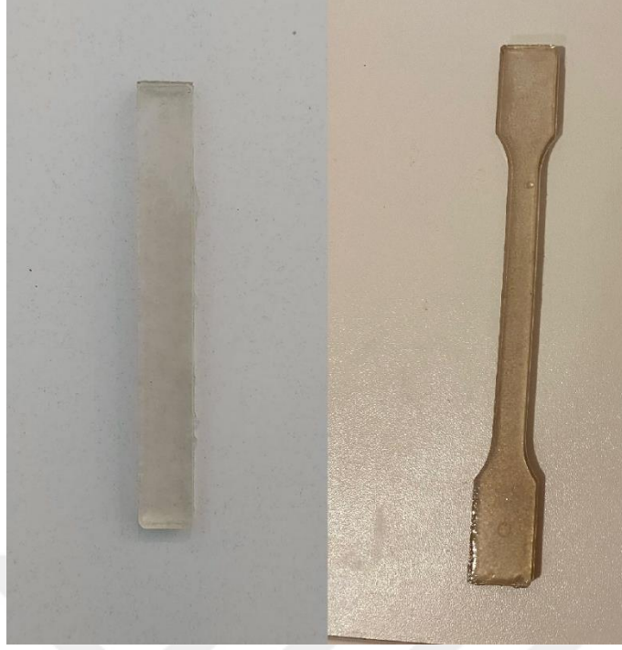
Şekil 4.8. Korona yöntemiyle yüzeyi modifiye edilen UHMWPE ilaveli poliestere kompozit test çubukları
