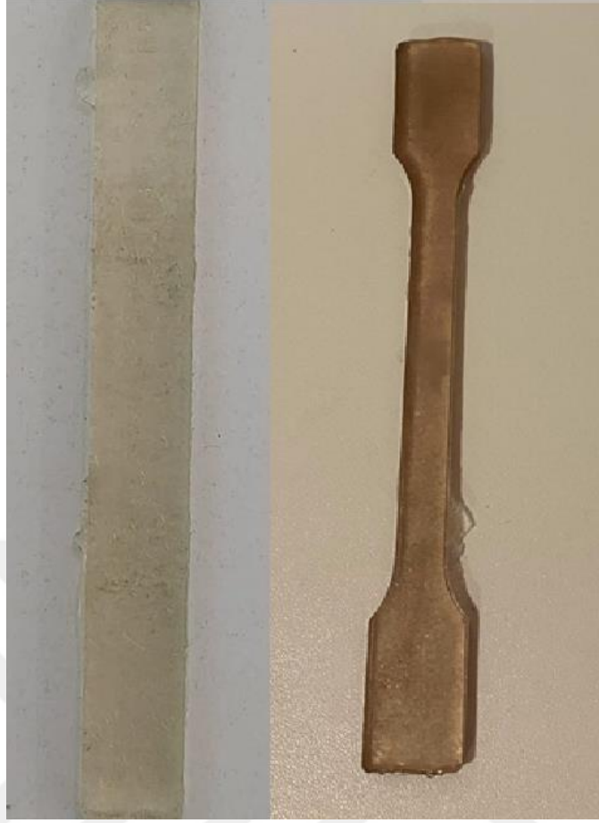
Şekil 4.10. Silan kaplama ile yüzeyi modifiye edilen UHMWPE ilaveli poliester kompozit test çubukları
