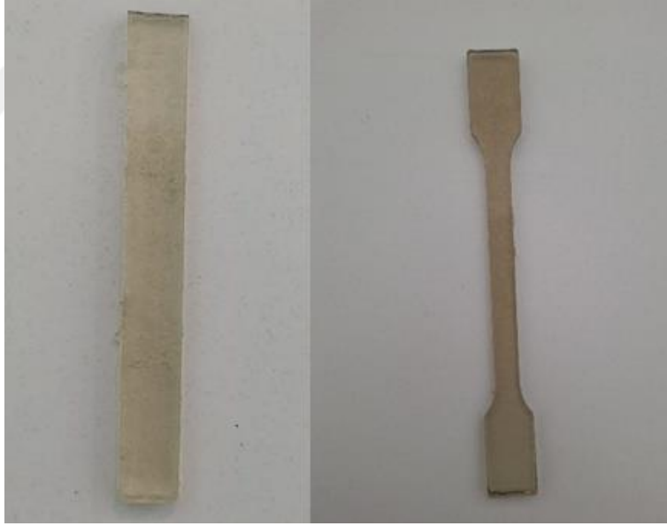
Şekil 4.9. HMDA kaplama ile yüzeyi modifiye edilen UHMWPE ilaveli poliestere kompozit test çubukları
