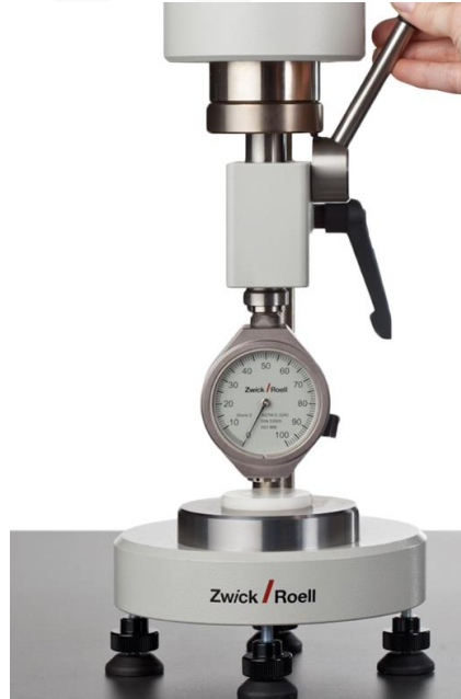
Şekil 4.12. Zwick Roell analog Shore-D sertlik cihazı [117]
