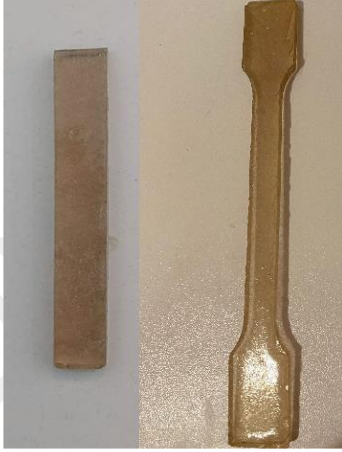
Şekil 4.7. Kromik asit ile yüzeyi modifiye edilen UHMWPE ilaveli poliester kompozit test çubukları
