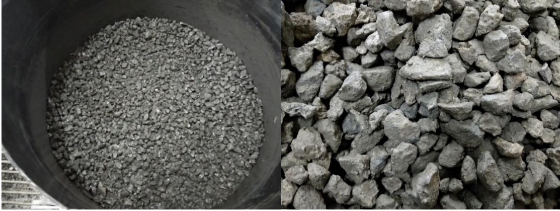
Şekil 2.15. 2. puzolan emdirme yöntemi ve betoniyerden alınan GDA'lar
