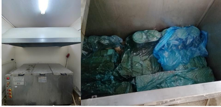
Şekil 2.37. Geopolimer betonlara buhar kürü uygulanması
