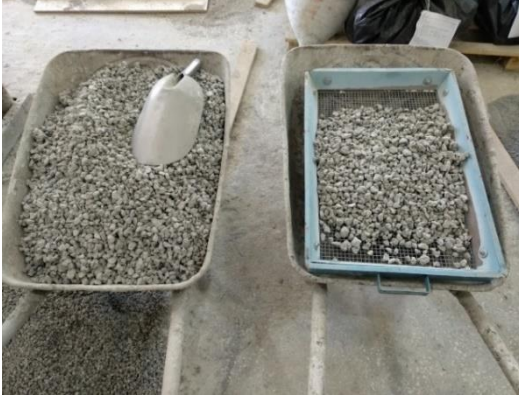
Şekil 2.27. Kuruyan GDA'ların elenmesi ve laboratuvarında muhafaza edilmesi
