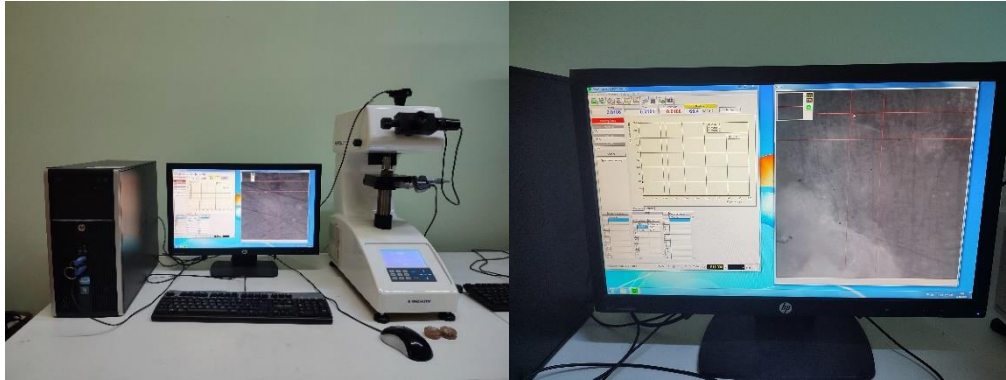
Şekil 2.57. Innovatest marka mikrosertlik cihazı ve mikrosertlik ölçümü
