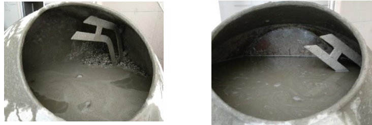
Şekil 2.19. 4. puzolan emdirme yöntemi ve betoniye alanan GDA'lar
