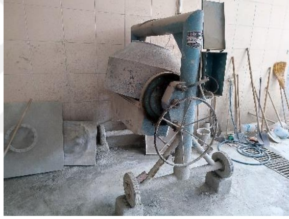
Şekil 2.35. Geopolimer beton üretiminde kullanılan 60 litre kapasiteli eğik eksenli betoniye
