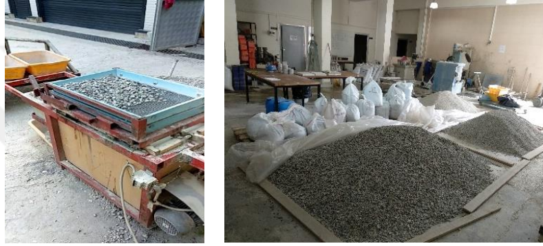
Şekil 2.2. GDA'nın elenmesi ve saklanması
