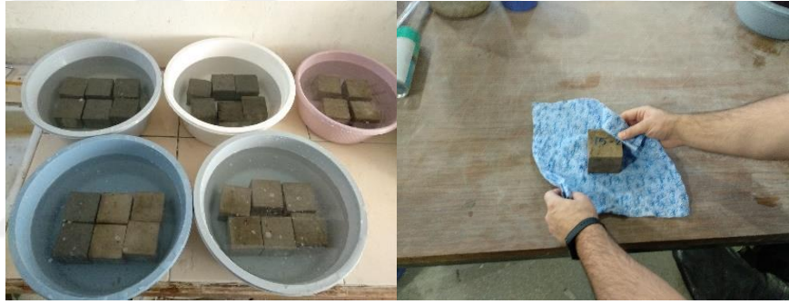
Şekil 2.45. Numunelerin doymun kuru yüzey hale getirilmesi
