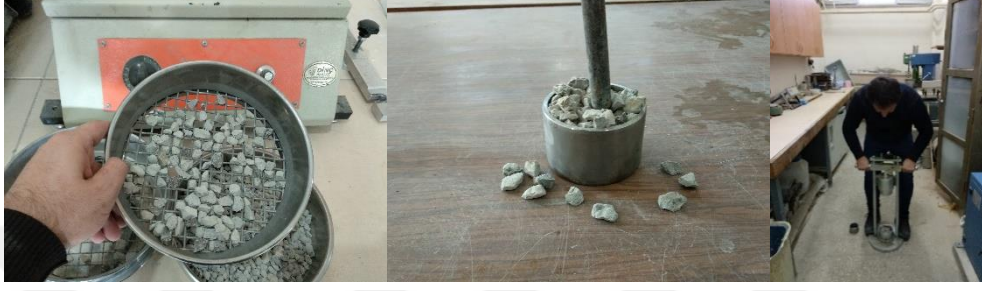
Şekil 2.31. Agregaların elenerek 12.5/10 mm arası malzemenin elde edilmesi, deney kabına yerleştirilmesi ve deneyin yapılışı
