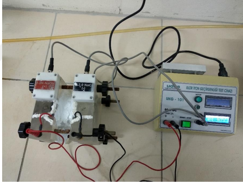
Şekil 2.49. Hızlı klorür geçirimsizlik deneyinin yapılışı
