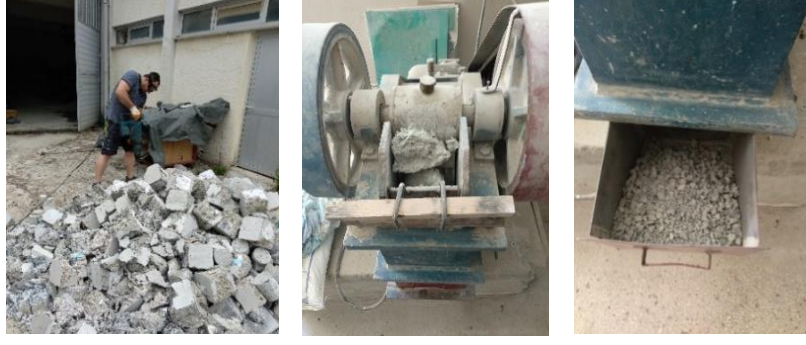
Şekil 2.1. Beton numunelerinin temini ve hilti ile parçalanması, çeneli kırıcıda kırılarak agrega boyutuna getirilmesi
