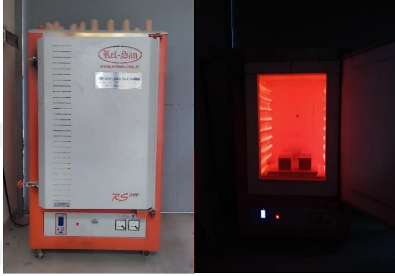
Şekil 2.55. Yüksek sıcaklık etkisi için kullanılan Ref-San marka fırın ve GPB’lere yüksek sıcaklık uygulanması
