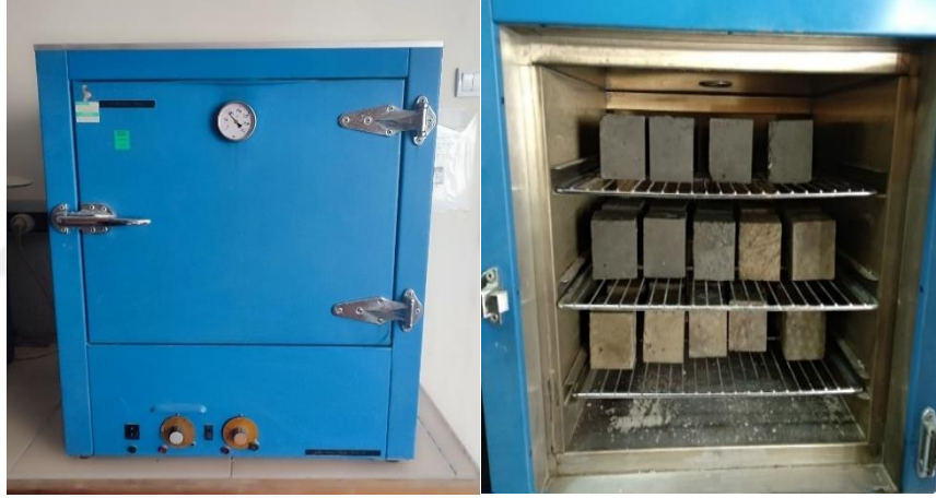
Şekil 2.43. Deney örneklerini kurutmak için kullanılan etüv ve numunelerin etüvde kurutulması
