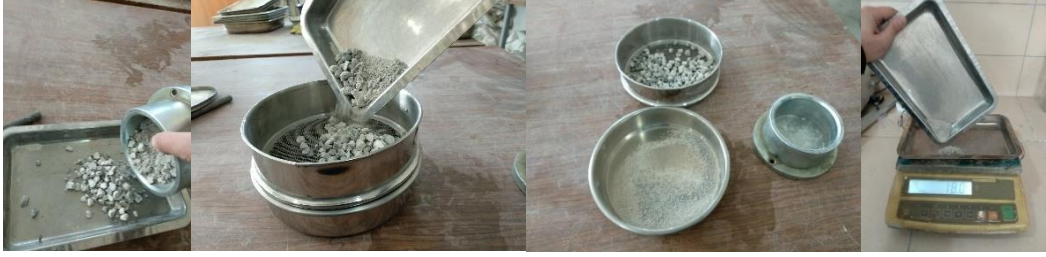
Şekil 2.32. Darbe deneyi sonunda agregaların 2.36 mm elekten elenerek kırılan ince malzeme miktarının belirlenmesi
