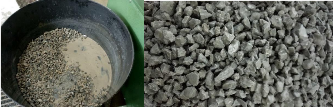
Şekil 2.13. 1. Pozolan emdirme yöntemi ve betoniyerden alınan GDA'lar
