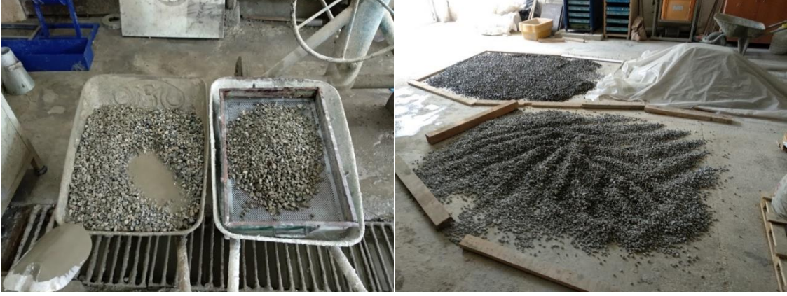
Şekil 2.20. Şerbet emdirilen GDA'ların betoniyerden alınması ve kurutulması
