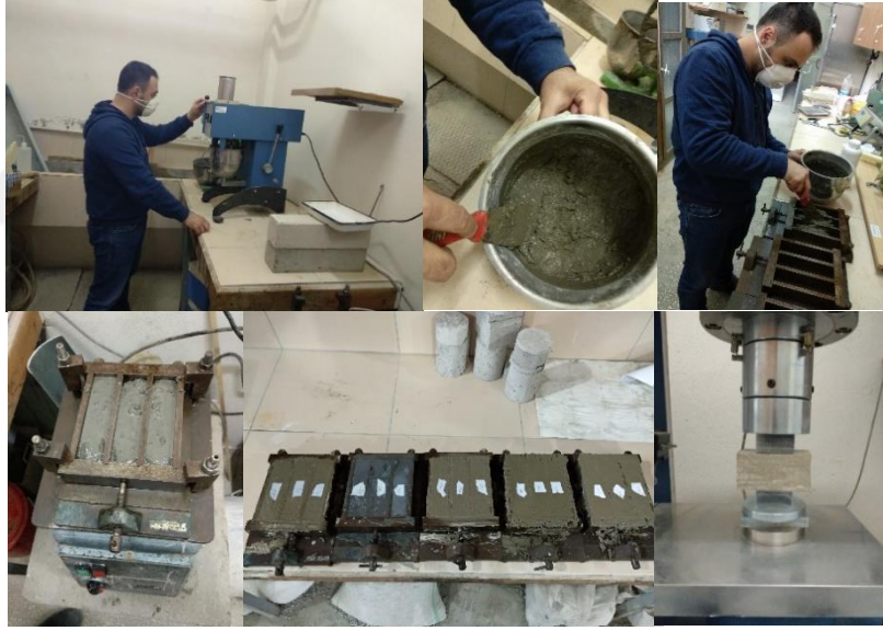
Şekil 2.11. Puzolanik maddelerin dayanım aktivite indekslerinin belirlenmesi için çimento harçları üretimi ve basınç deneyi
