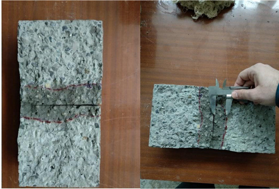
Şekil 2.47. Basınçlı su işleme derinliğinin ölçümü
