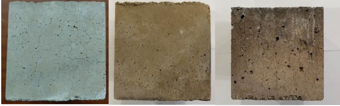
Şekil 3.46. Soldan sağa 300, 600 ve 900 °C sıcaklık etkisi sonunda GPB numunelerinin görselleri
