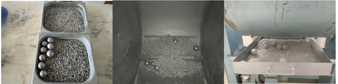
Şekil 2.29. Deneye hazır hale getirilen agrega ve bilyalar, bilyaların tambura konulması ve aşındırılan agregaların deney sonunda tamburdan alınması
