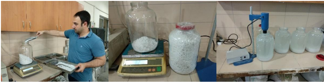
Şekil 2.34. Sodyum hidroksit çözeltisinin hazırlanması
