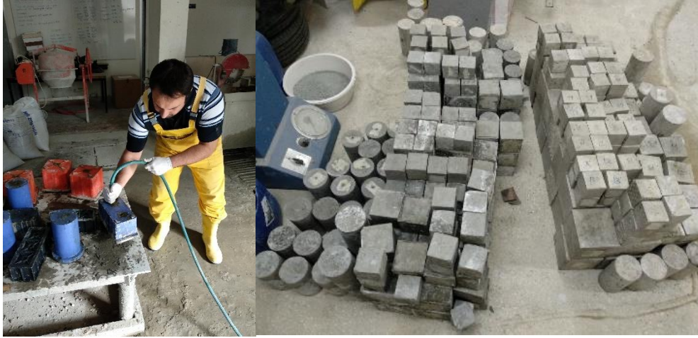
Şekil 2.38. Geopolimer betonların kalıplardan çıkarılması ve laboratuvar ortamında saklanan numuneler
