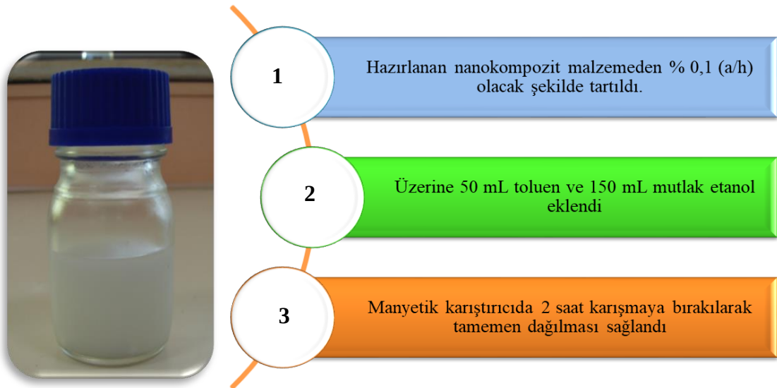
Şekil 3.6 : Nanokompozit kaplama malzemesinin hazırlanması.
