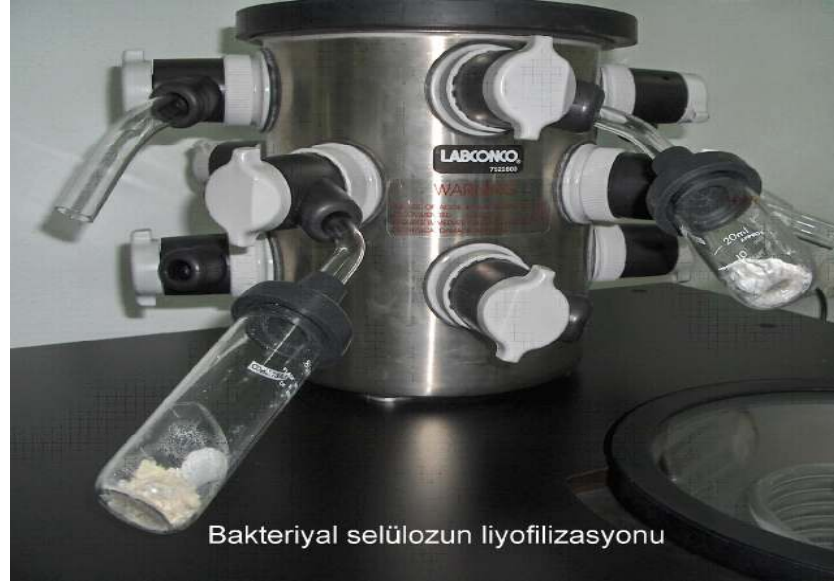
Şekil 4.13 Saflaştırılmış bakteriyal selülozun liyofilizatörde kurutulma şekli
