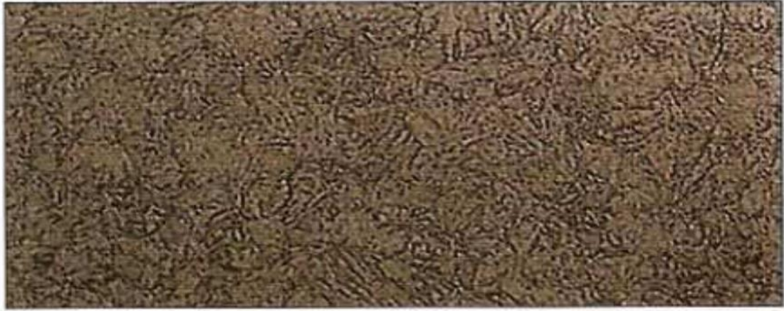
Şekil 2.3. Martenzitik Paslanmaz çeliğe ait mikroyapı görüntüsü [7]
