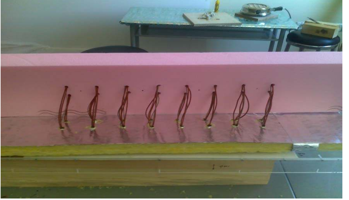
Şekil 3.7. Foamboard (XPS) yalıtım malzemesinin montajı
