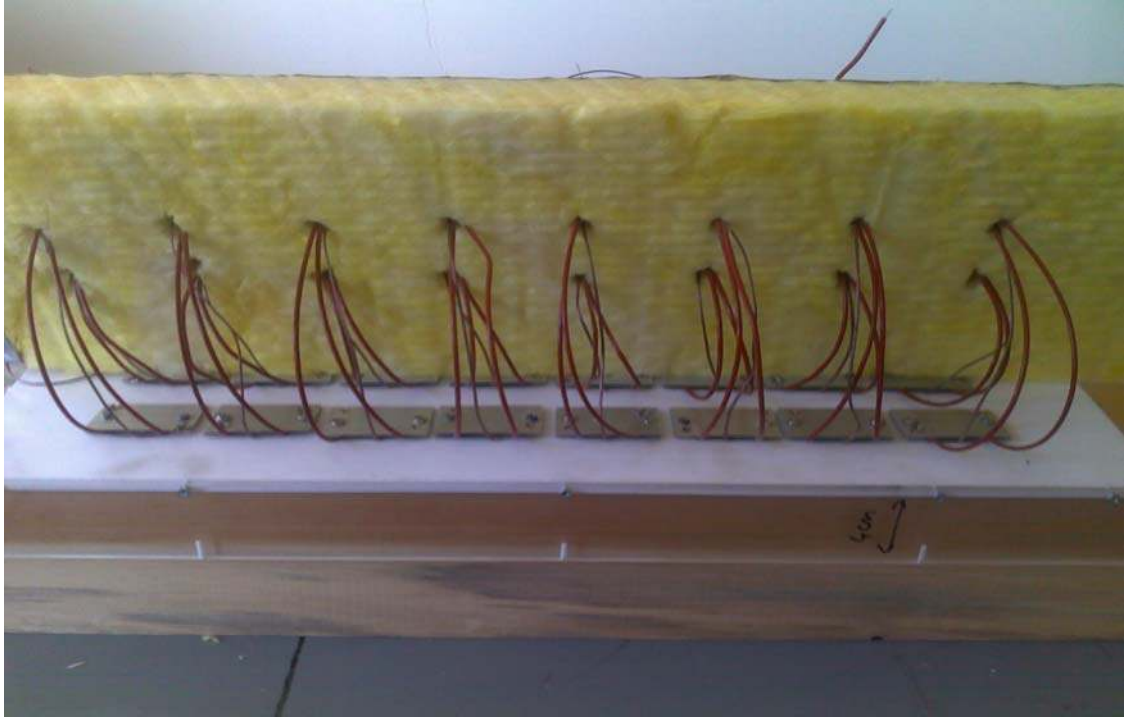
Şekil 3.6. Isıtıcıların cam yünü ile kaplanması
