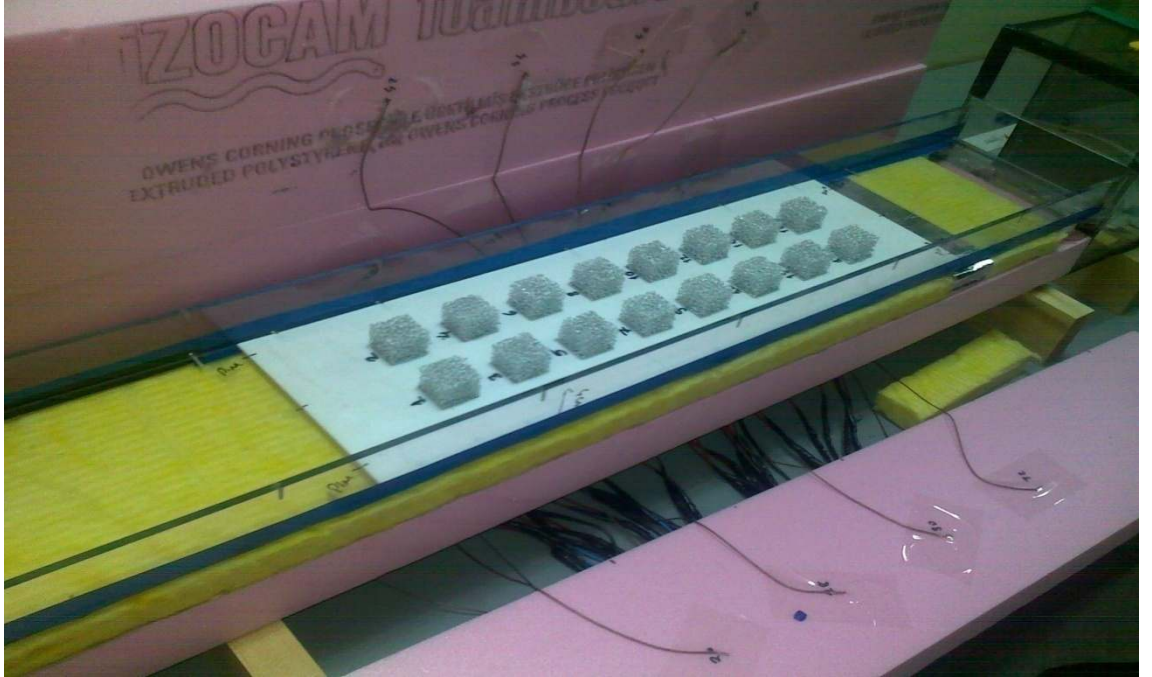
Şekil 3.10. Alüminyum köpük blokların test bölgesine yerleşimi
