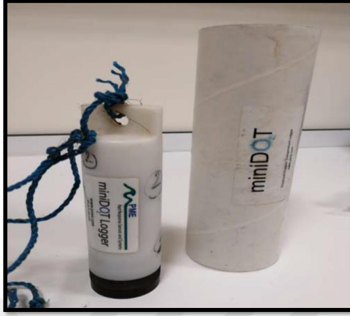
Şekil 4.2. Çalışmada çözünmüş oksijen ( \text{ÇO} ) ve su sıcaklığı ( T_{\text{su}} ) ölçümleri için kullanılan PME MiniDOT Data Logger cihazı.
