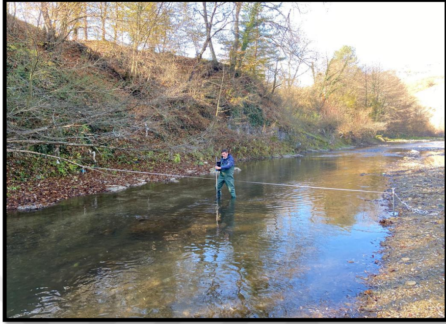
Şekil 4.3. Akarsu yatağında su debisi (Q), su hızı (V), derinlik (D) ve genişlik (W) ölçümü.
