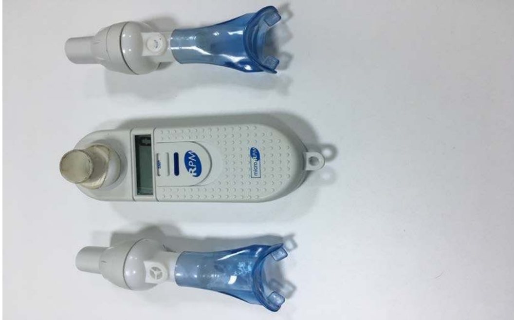
Resim 3.2. Solunum kas kuvveti cihazı
